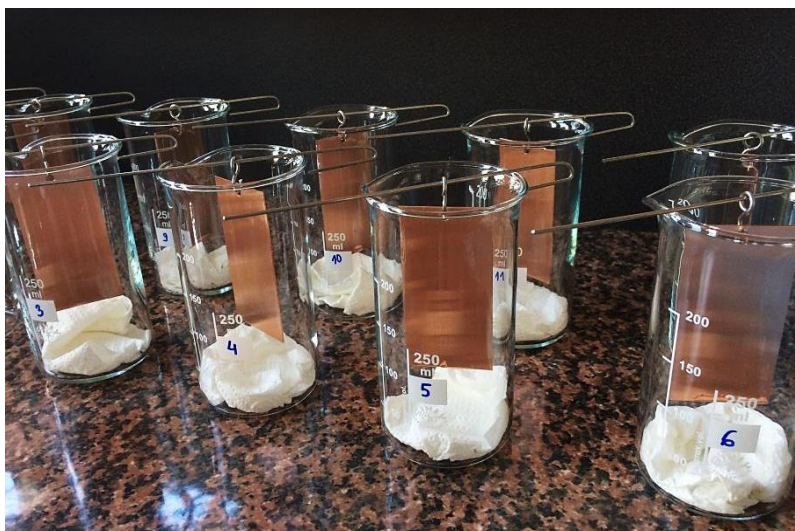
Slika 3.8. Sušenje bakrenih pločica.
