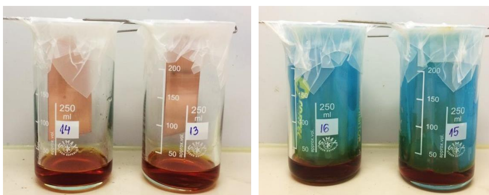
Slika 3.17. Uzorci izloženi djelovanju joda u čaši bez i s inhibitorom.
