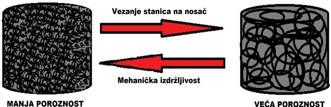
Slika 2. Odnos poroznosti biomaterijala – nosača, bioaktivnosti i mehaničkih svojstava [6].
