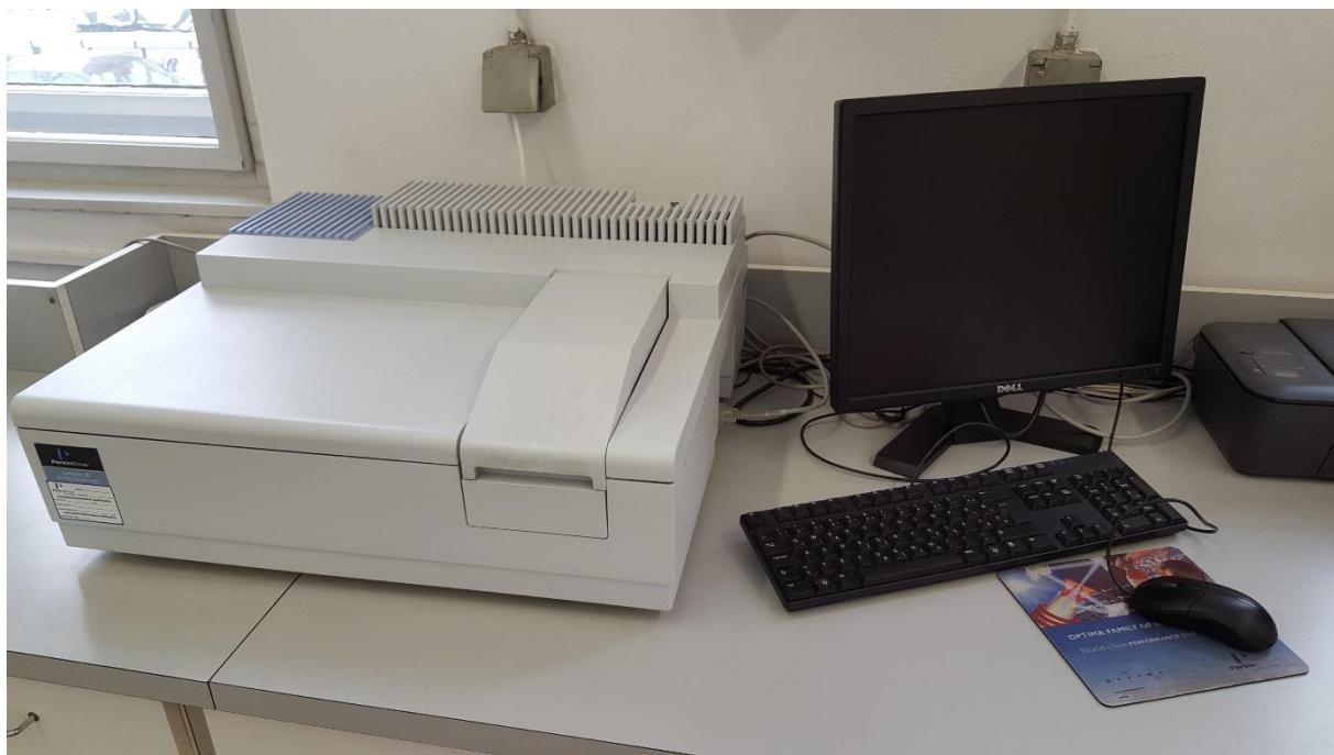
**Slika 7.** Perkin Elmer Lambda 35 spektrofotometar
