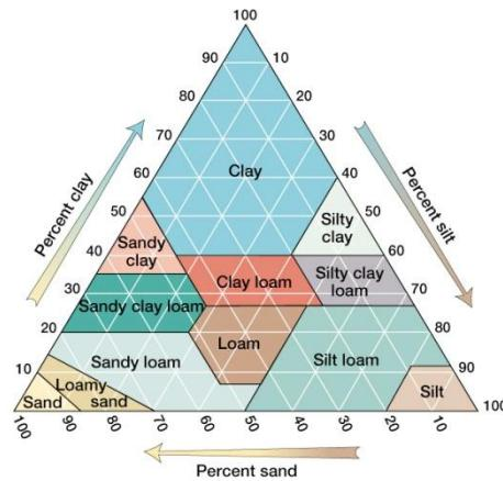
**Slika 7.** Atterbergov trokut za određivanje teksturne klase tla na temelju udjela gline, praha i pijeska (*Clay* – glina, *Sandy clay* – praškasta glina, *Silty clay loam* – praškasto glinena ilovača, *Silt loam* – praškasta ilovača, *Silt* – prah, *Loam* – ilovača, *Clay loam* – glinasta ilovača, *Sandy clay loam* – praškasto glinasta ilovača, *Sandy clay* – pjeskovita glina, *Sandy loam* – pjeskovita ilovača, *Loamy sand* – ilovasti pijesak i *Sand* – pijesak) [16, 20]
