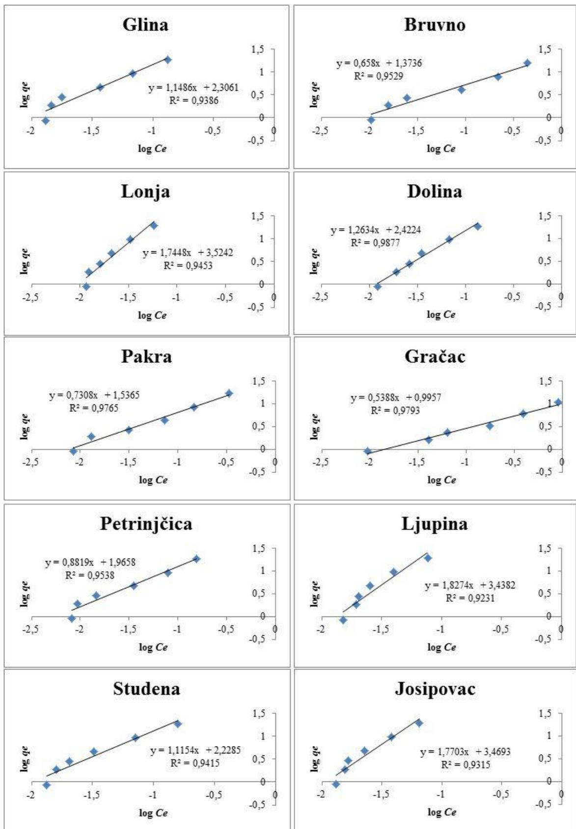
Slika 30. Rezultati primjene Freundlichova modela na eksperimentalne podatke sorpcije cefdinira na sedimente (lijevi stupac) i tla (desni stupac) uz 0,01 M CaCl<sub>2</sub>
