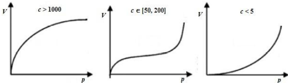
Slika 16. Različiti tipovi B. E. T. izotermi u ovisnosti o vrijednosti konstante  $c$  [32]
