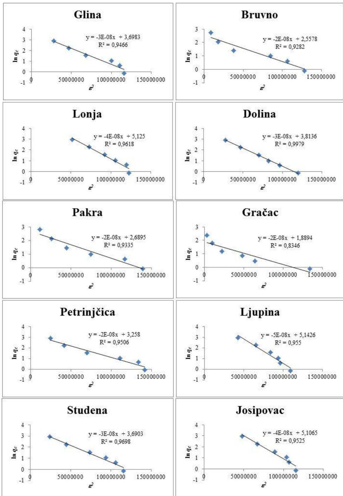
Slika 31. Rezultati primjene Dubinin-Radushkevicheva modela na eksperimentalne podatke sorpcije cefdinira na sedimente (lijevi stupac) i tla (desni stupac) uz 0,01 M CaCl<sub>2</sub>
