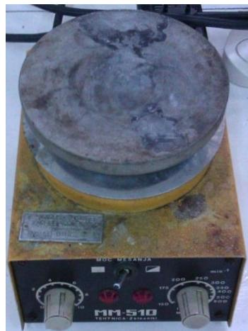
Slika 24. Magnetska mješalica Tehnica Železniki MM-510
