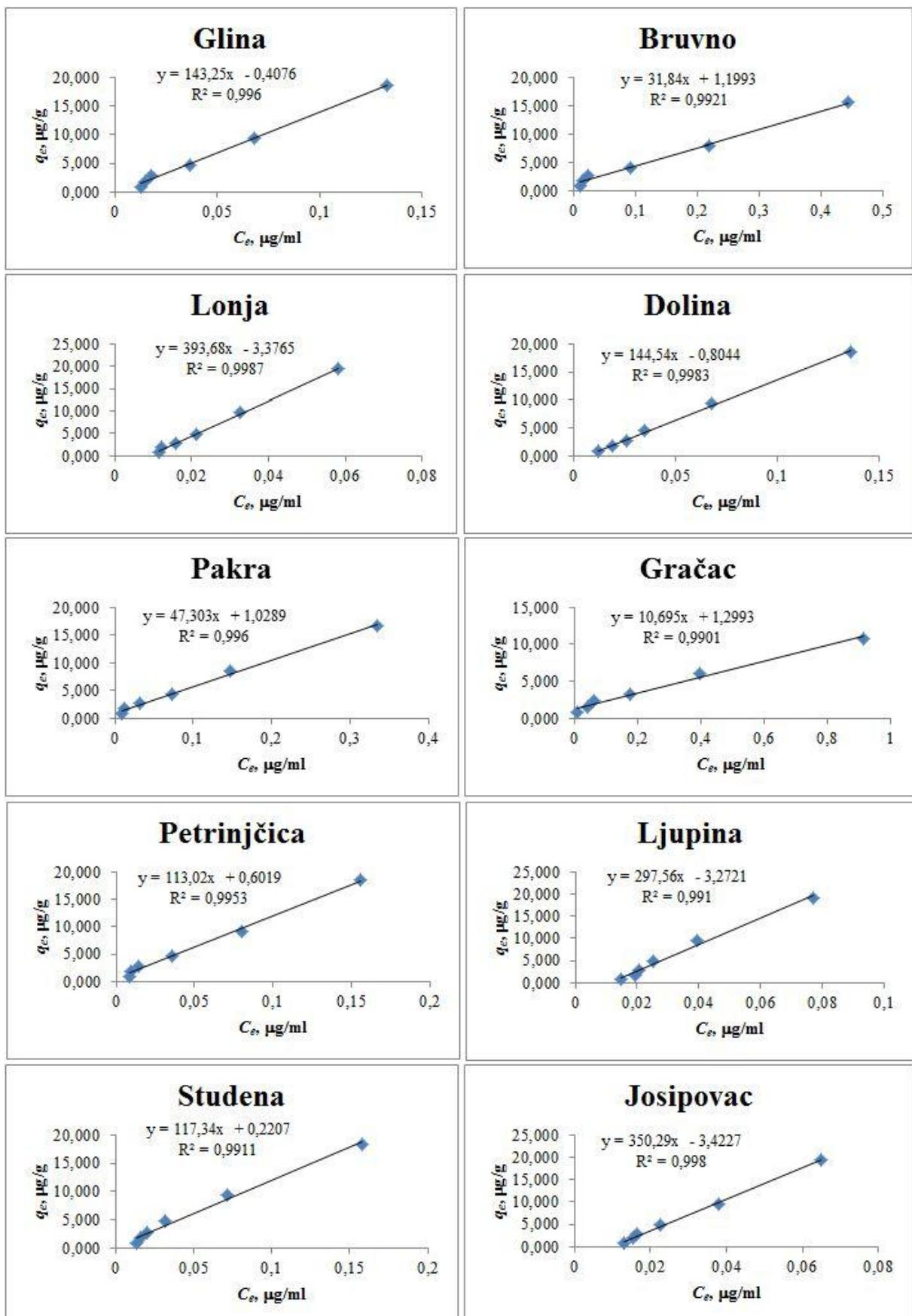
Slika 29. Rezultati primjene Linearnog modela na eksperimentalne podatke sorpcije cefdinira na sedimente (lijevi stupac) i tla (desni stupac) uz 0,01 M CaCl<sub>2</sub>
