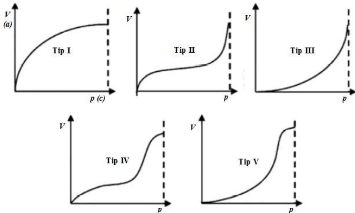
Slika 10. Pet osnovnih tipova sorpcijskih izotermi [33]
