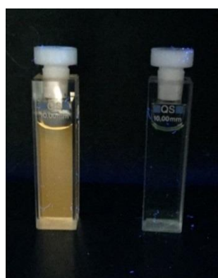
Slika 28. (a) Apsorpcijski spektar spoja 7 u otopinama univerzalnog puferarazličitih pH vrijednosti; (b) emisijski spektar spoja 7 u otopinama univerzalnog pufera različitih pH vrijednosti; (c) otopina spoja 7 u univerzalnom puferu pH vrijednosti 7,00 (lijevo) i 1,00 (desno).
