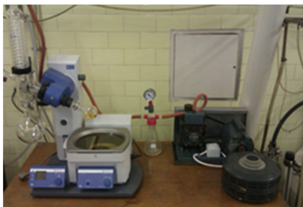
Slika 8. Rotacijski vakuum isparivač IKA RV 10 basic korišten za sintezu eutektičkih otapala.
