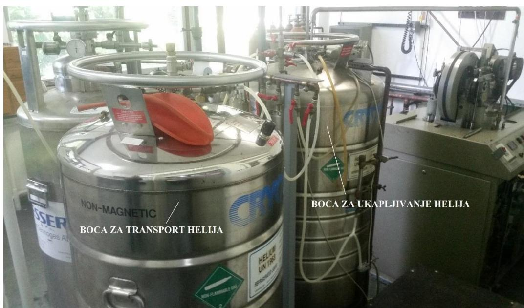
Slika 25. Boce za helij ( nehrđajući čelik + superizolacija )
