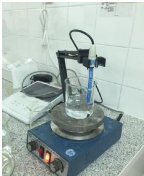
Slika 3.5. pH metar i magnetska miješalica
