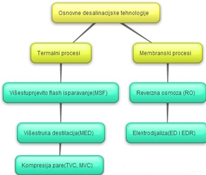
Slika 5. Shematski prikaz osnovnih desalinacijskih tehnologija [2].
