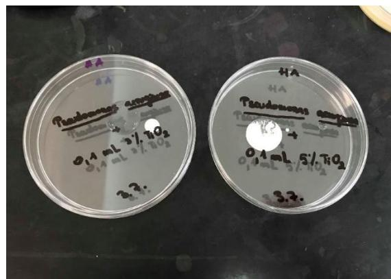
**Slika 3.10.** Određivanje prijenosa antimikrobnih sastojaka prema Normi EN ISO 846:1997<sup>54</sup> u pokusu P2
