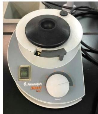
**Slika 3.5.** Homogenizator REAX top.
