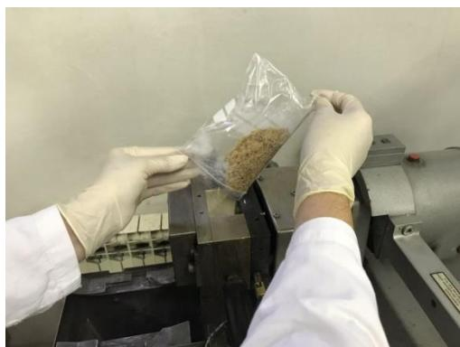
**Slika 3.11.** Priprema LDPE/RLJ kompozita u Brabender gnjetilici.
