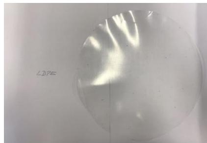
**Slika 4.9.** Film izrađen od čistog polietilena niske gustoće.
