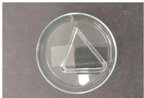
**Slika 3.12.** Određivanje prijenosa antimikrobnih sastojaka prema Normi ISO 22196<sup>55</sup>.
