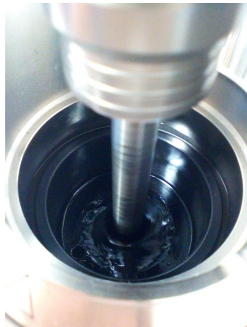
Slika 3.3. Uzorak u posudi za vrijeme reoloških ispitivanja
