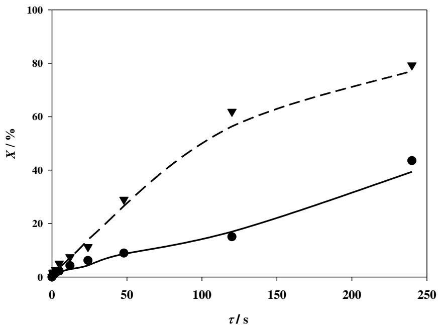
**Slika 22.** Ovisnost konverzije fenola o vremenu zadržavanja u sustavu voda-heksan u mikroreaktoru ((●)  $c_{\text{u,fenol}} = 6 \text{ mmol dm}^{-3}$ , (▼)  $c_{\text{u,fenol}} = 3 \text{ mmol dm}^{-3}$ , (—) model,  $\gamma_{\text{u,lakaza}} = 0,2 \text{ g dm}^{-3}$ )
