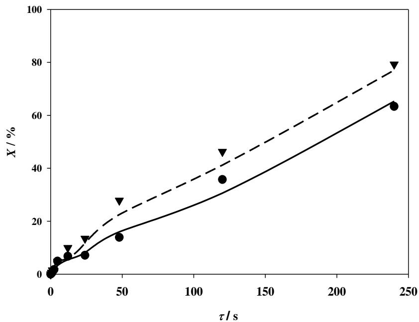
**Slika 21.** Ovisnost konverzije fenola o vremenu zadržavanja u sustavu voda-diklormetan u mikroreaktoru ((●)  $c_{u,\text{fenol}} = 6 \text{ mmol dm}^{-3}$ , (▼)  $c_{u,\text{fenol}} = 3 \text{ mmol dm}^{-3}$ , (—) model,  $\gamma_{u,\text{lakaza}} = 0,2 \text{ g dm}^{-3}$ )
