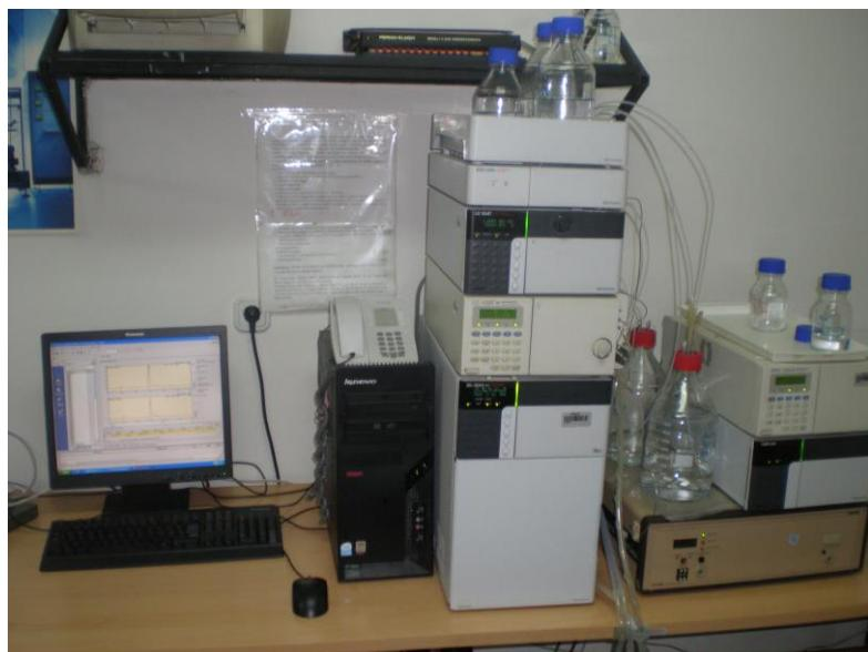
Slika 5. HPLC korišten za određivanje koncentracije fenola
