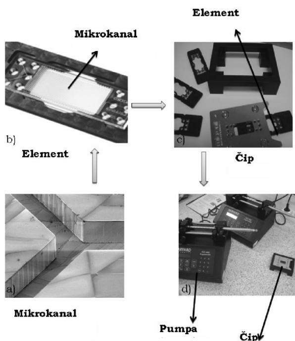
**Slika 1.** Osnovne strukturne jedinice mikroreaktorskog sustava.<sup>1</sup>
