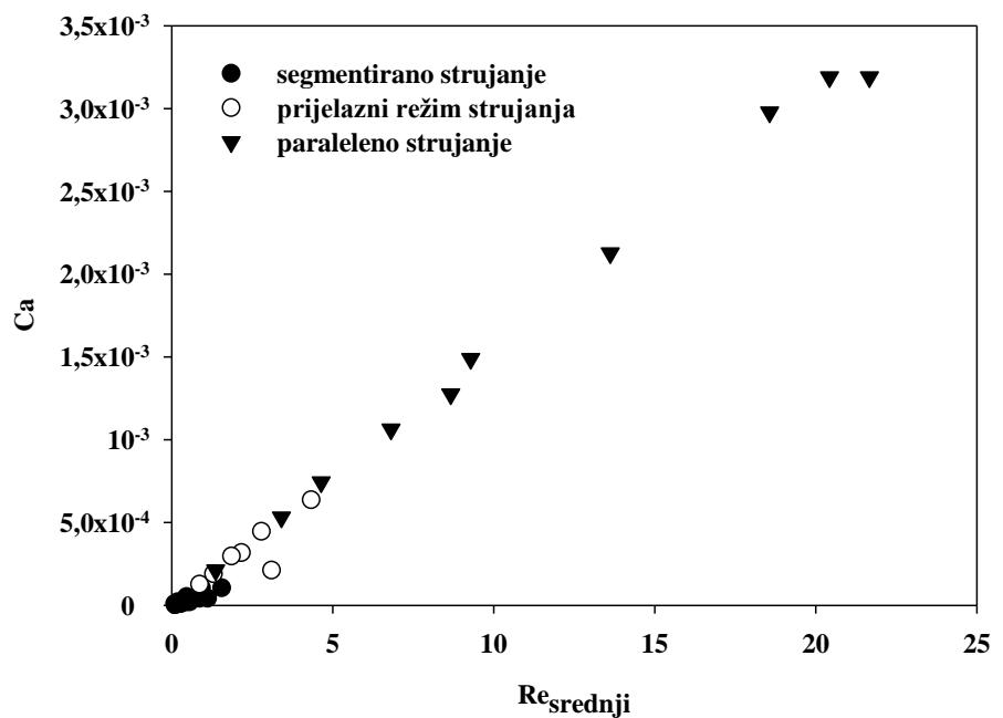
**Slika 18.** Zavisnost kapilarnog broja o srednjem Reynoldsovom broju za strujanje sustava voda-heksan u mikroreaktoru
