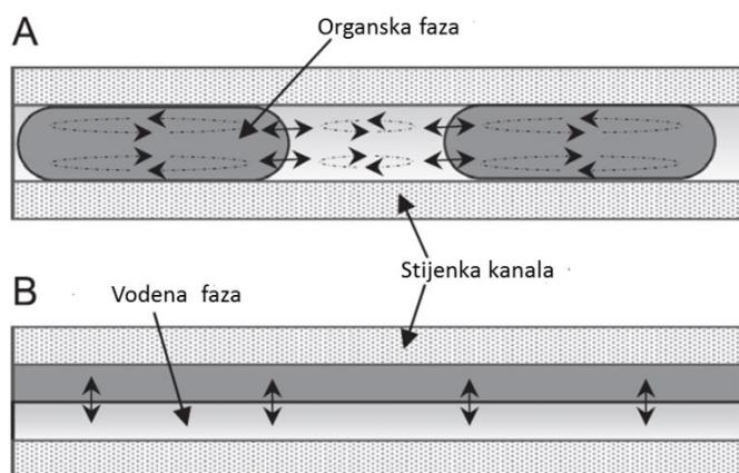
**Slika 2.** Oblici strujanja u mikrokanalu u sustavu kapljevina-kapljevina: (A) segmentirano strujanje, (B) paralelno strujanje.<sup>6</sup>
