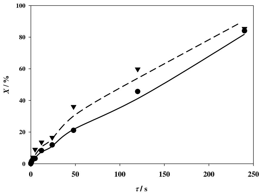
**Slika 23.** Ovisnost konverzije fenola o vremenu zadržavanja u sustavu voda-toluen u mikroreaktoru ((●)  $c_{\text{u,fenol}} = 6 \text{ mmol dm}^{-3}$ , (▼)  $c_{\text{u,fenol}} = 3 \text{ mmol dm}^{-3}$ , (—) model,  $\gamma_{\text{u,lakaza}} = 0,2 \text{ g dm}^{-3}$ )
