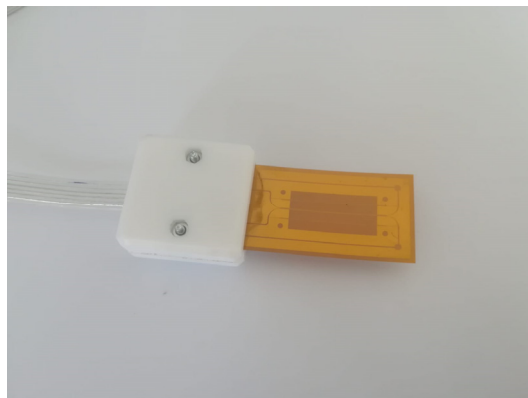
Slika 17. Senzor za krute uzorke korišten za mjerenje toplinske vodljivosti nanokompozitnih sustava
