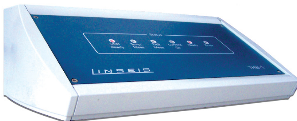
Slika 16. Transient Hot Bridge – uređaj kojim su provedena mjerenja
