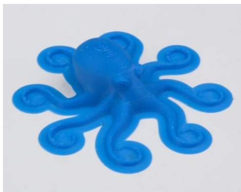
Slika 10. Prikaz 3D-tiskanom modela s opcijom brim
