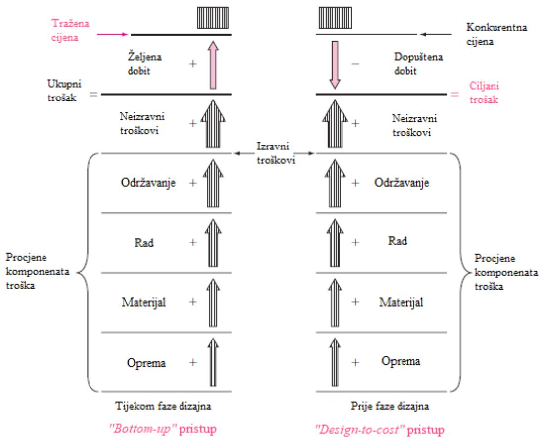
**Slika 1.**Pojednostavljeni postupci procjene troškova za pristupe „bottom-up“ i „design-to-cost“<sup>3</sup>
