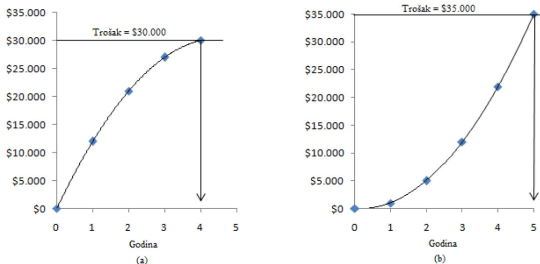
Slika 6. Grafovi za analizu perioda povrata za stroj (a) A i (b) B<sup>2</sup>
