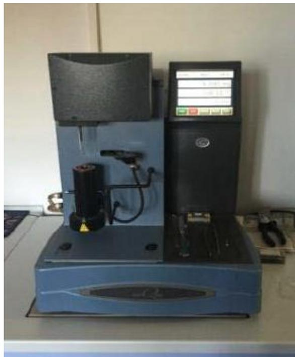
**Slika 19.** Uređaj za termogravimetrijsku analizu Q500
