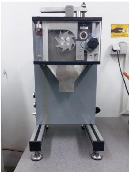
**Slika 23.** Uređaj za usitnjavanje polimernog materijala
