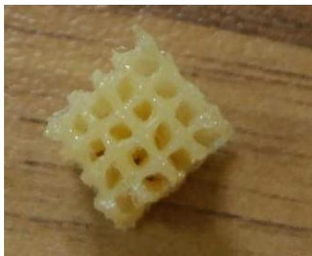
**Slika 53.** Obloženi Z-PCABS nosač nakon zagrijavanja na 180 °C
