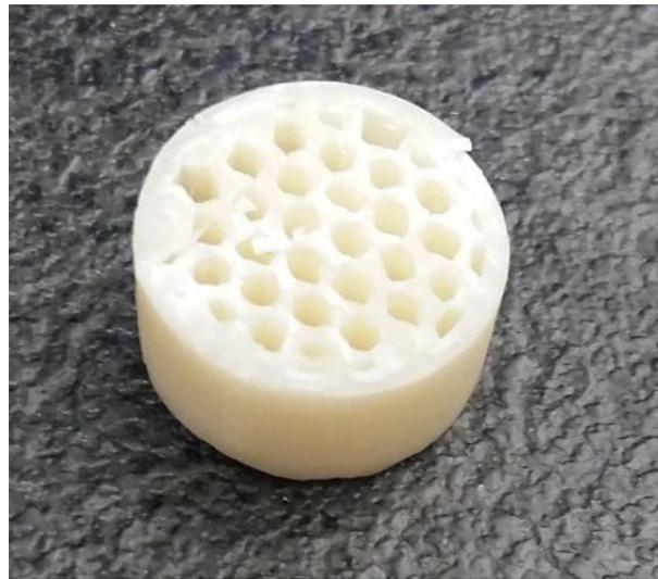
**Slika 48.** Prikaz 3D-modela i konačnog proizvoda saćaste strukture, 40 %-tne gustoće punjenja
