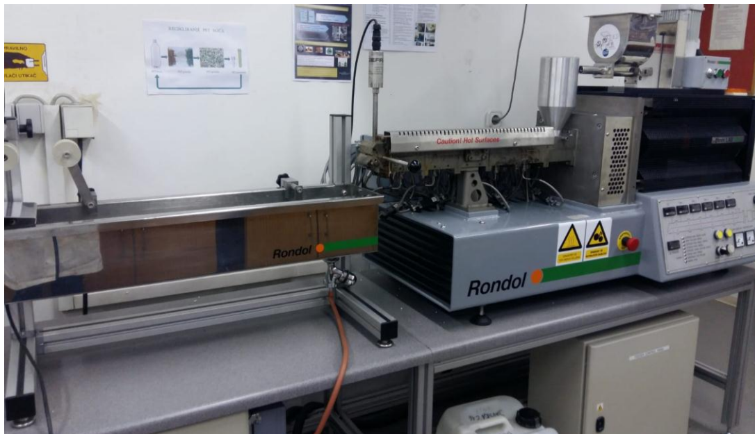
Slika 22. Dvopužni ekstruder Rondol 21 mm LAB TWIN
