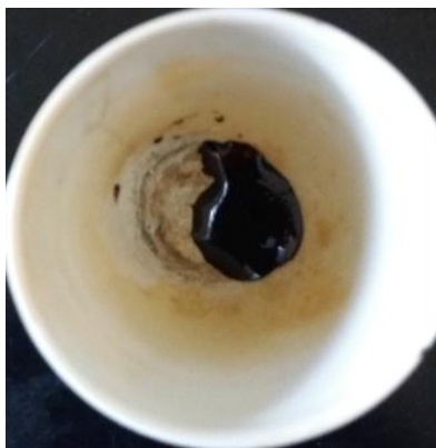
Slika 51. Prikaz Z-PCABS i Z-GLASS nosača nakon zagrijavanja na 300 °C i 350 °C
