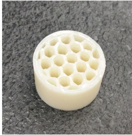
**Slika 47.** Prikaz 3D-modela i konačnog proizvoda saćaste strukture, 30 %-tne gustoće punjenja
