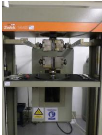
Slika 26. Kidalica Zwick, UTM 1445
