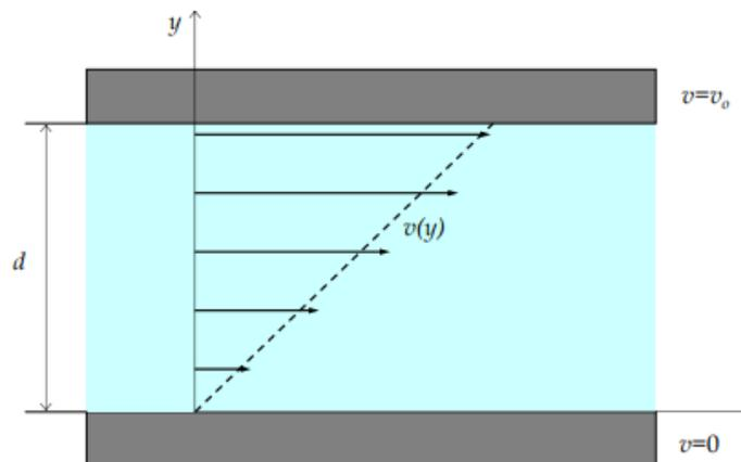
**Slika 5.** Newtonov pokus za određivanje viskozne sile<sup>13</sup>
