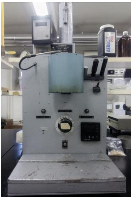
**Slika 27.** Uređaj za određivanje masenog protoka taljevine
