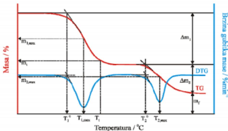
**Slika 18.** Prikaz određivanja značajki termogravimetrijskih krivulja<sup>59</sup>
