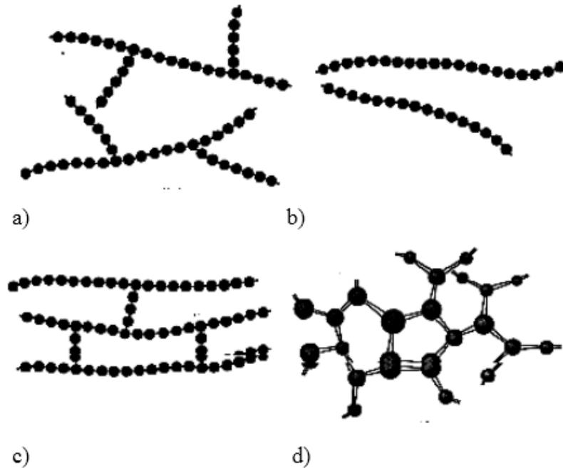
**Slika 2.** Podjela polimera prema obliku makromolekule: a) linearni, b) razgranati, c) umreženi, d) trodimenzionalni<sup>6</sup>
