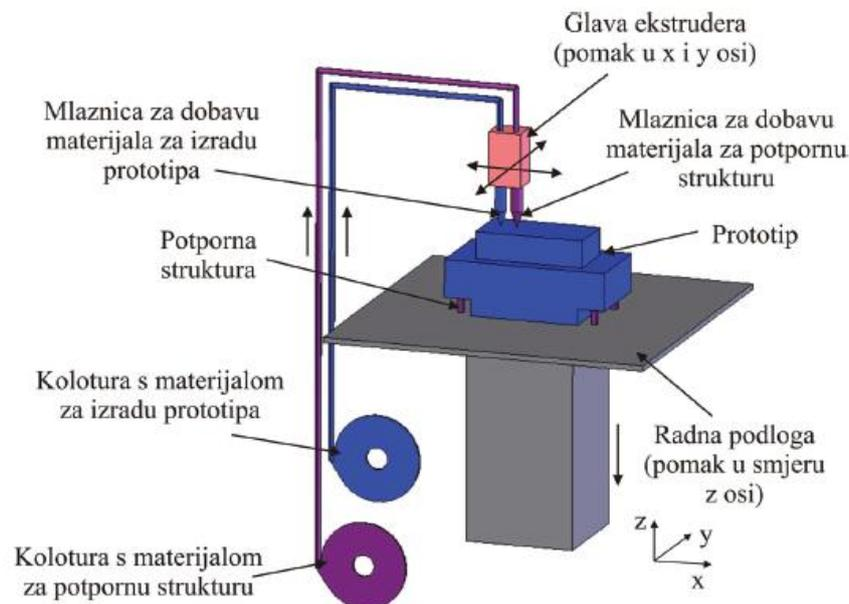
**Slika 16.** Postupak proizvodnje rastaljenim filamentom<sup>42</sup>
