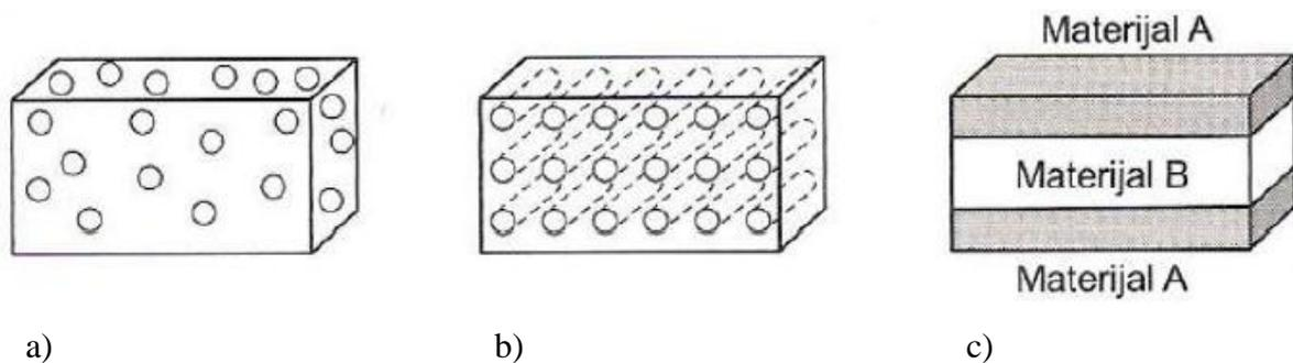
**Slika 13.** Osnovna podjela kompozita: a) kompoziti s česticama, b) vlaknima ojačani kompoziti, c) slojeviti kompoziti<sup>31</sup>
