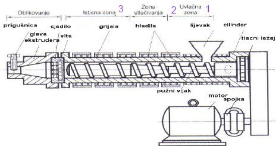
**Slika 17.** Shematski prikaz uređaja za ekstrudiranje<sup>49</sup>
