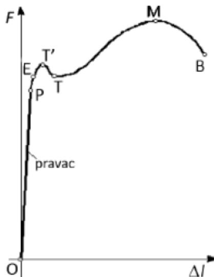
**Slika 3.** Grafički prikaz karakterističnih područja i točki na deformacijskoj krivulji<sup>10</sup>
