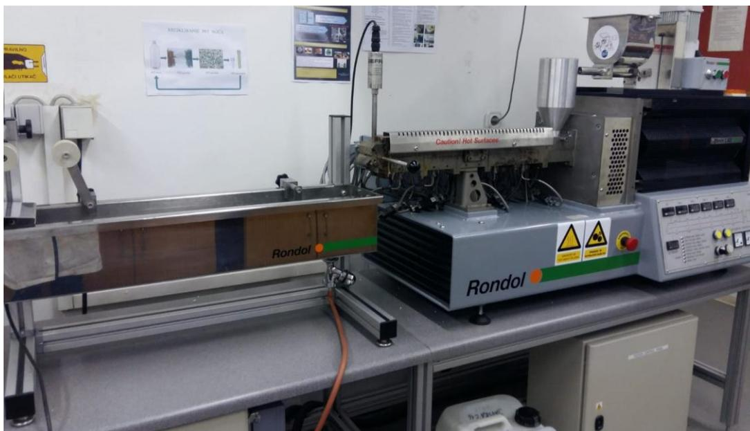
**Slika 22.** Dvopužni ekstruder Rondol 21 mm LAB TWIN
