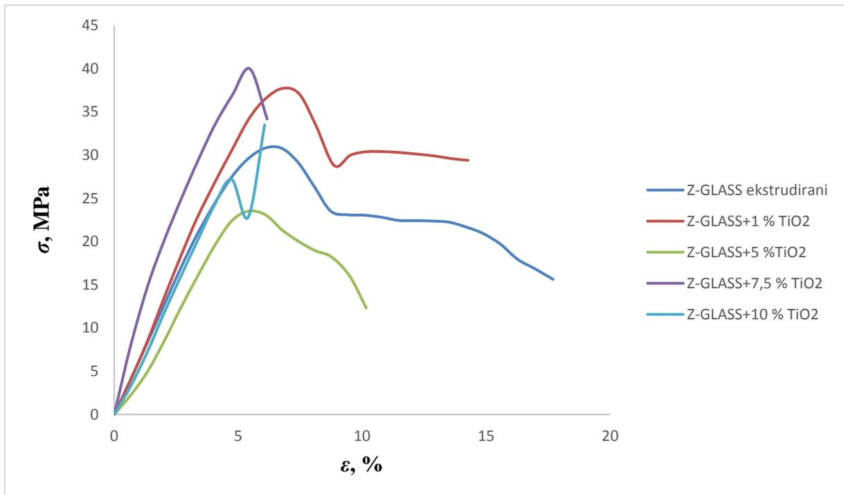
**Slika 56.** Grafički prikaz ovisnosti naprežanja o istežanju pripremljenih polimernih materijala s različitim udjelima TiO<sub>2</sub>
