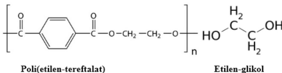
**Slika 12.** Strukture komponenti PET-G-a<sup>29,30</sup>
