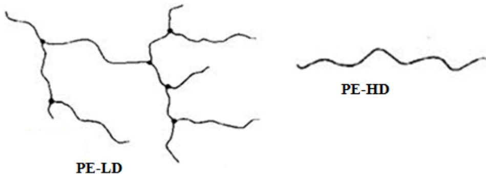
**Slika 11.** Usporedba struktura polietilena niske i visoke gustoće<sup>26</sup>
