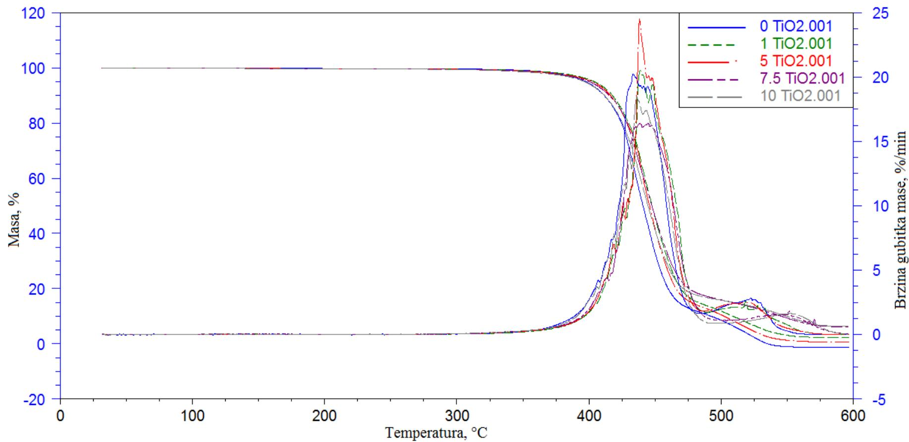
**Slika 43.** TG i DTG krivulje polimernih kompozita i čistog Z-GLASS-a
