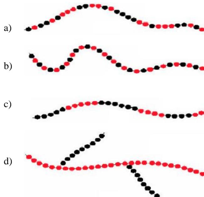
**Slika 1.** Prikaz strukturnih građa kopolimera: a) statistička, b) alternirajući kopolimeri, c) blok kopolimeri, d) cijepljeni ili graft kopolimeri<sup>3</sup>
