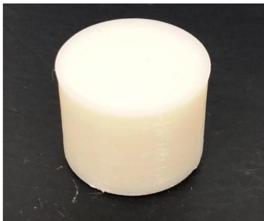
**Slika 50.** Testni polimerni nosač s formiranom kapicom
