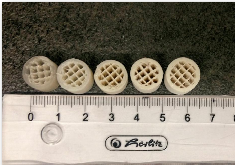
Slika 55. Izrađeni monolitni katalizatori od kompozitnog materijala Z-GLASS + \text{TiO}_2 različitih koncentracija (s lijeva na desno: 0 %, 1 %, 5 %, 7,5 % i 10 %)
