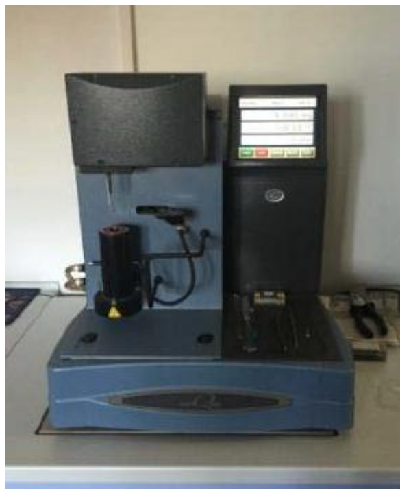
Slika 19. Uređaj za termogravimetrijsku analizu Q500
