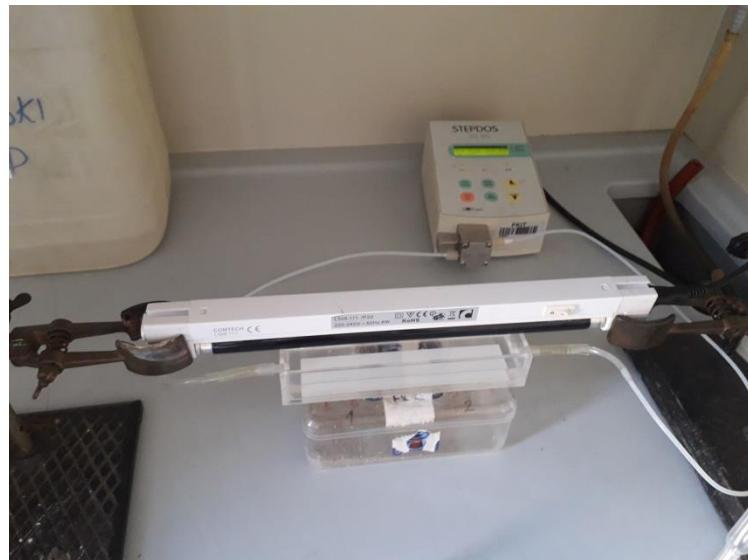
Slika 8: Korištena aparatura za ispitivanje fotokatalitičke aktivnosti.
