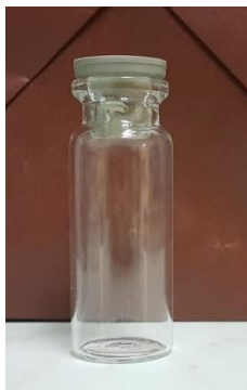
Slika 3.1. Kotlasti reaktor V = 5\text{ cm}^3
