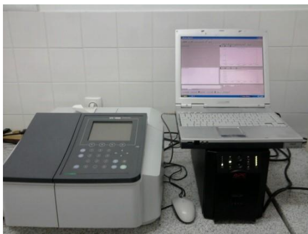
Slika 3.4.. Spektrofotometar Shimadzu UV-1800
