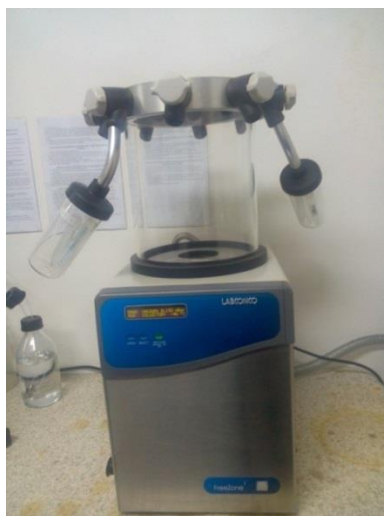
Slika 3.6. Liofilizator LABCONCO Free Zone
