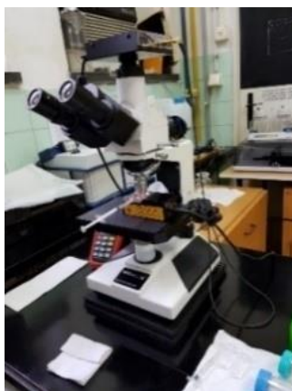
Slika 3.9.. Uređaj Malvern Nanosight LM10
