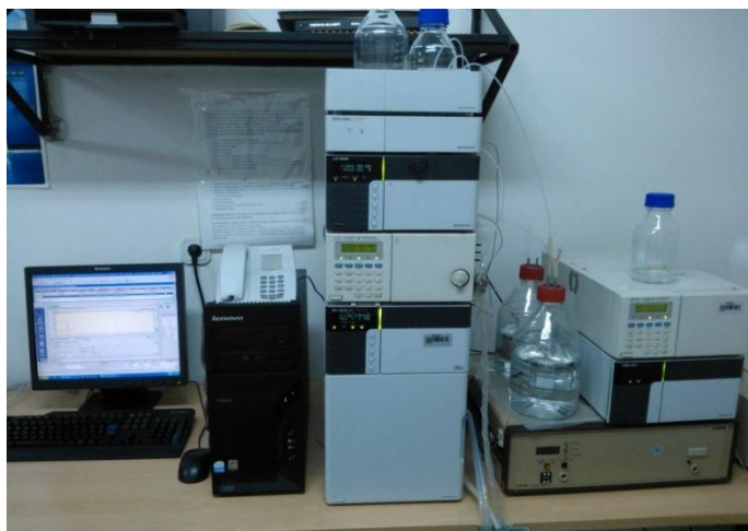
Slika 3.7. HPLC Shimadzu modularni sustav
