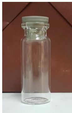
Slika 3.1. Kotlasti reaktor V = 5\text{ cm}^3
