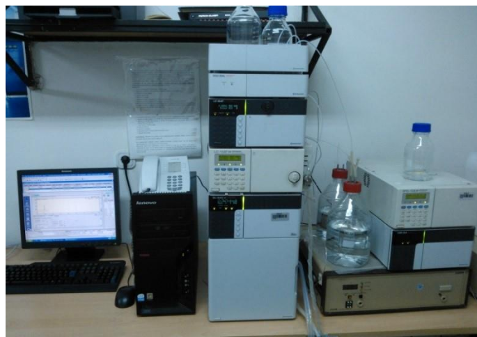
Slika 3.7. HPLC Shimadzu modularni sustav
