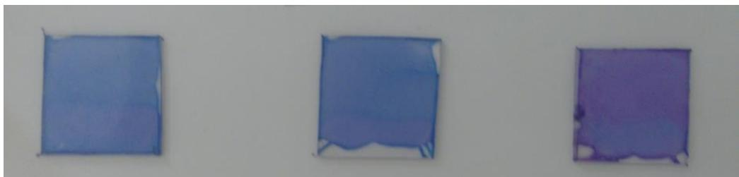
Slika 20. Pločice od Z-GLASS-a s nanesenim filmom NB/PVC i njihovo obojenje nakon kondicioniranja u kiselom puferu (lijevo), neutralnom puferu (sredina) i lužnatom puferu (desno)
