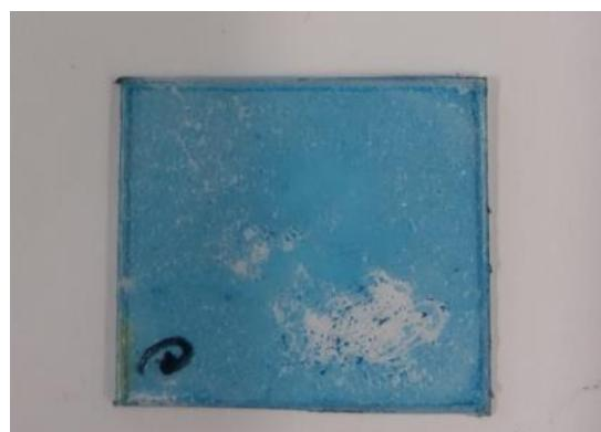
Slika 23. Pločica Z-GLASS-a s filmom BTG koja nije zadovoljila prvi test preliminarnog ispitivanja
