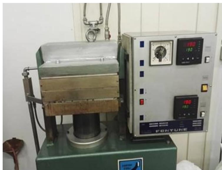
Slika 8. Hidraulička preša korištena za prešanje usitnjenih polimernih filamenata
