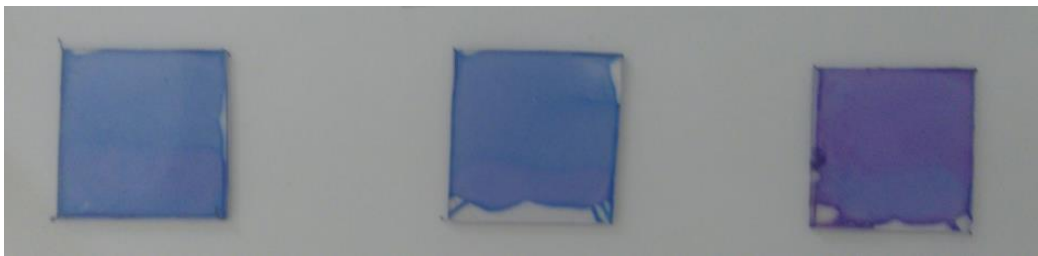
Slika 20. Pločice od Z-GLASS-a s nanesenim filmom NB/PVC i njihovo obojenje nakon kondicioniranja u kiselom puferu (lijevo), neutralnom puferu (sredina) i lužnatom puferu (desno)
