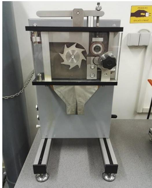
Slika 7. Sjeckalica korištena za usitnjavanje polimernih filamenata
