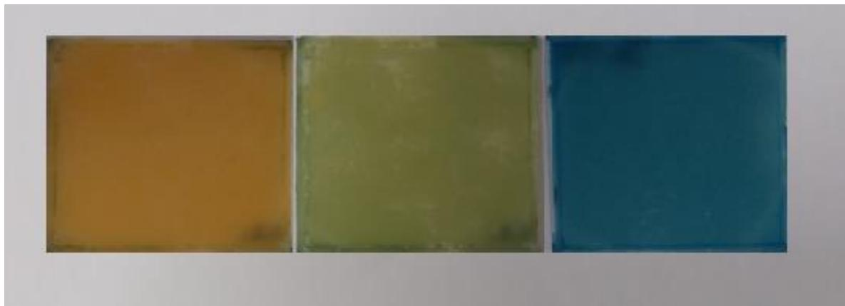
Slika 26. Film BTF na pločici Z-PCABS-a nakon kondicioniranja u kiseloj (lijevo), neutralnoj (sredina) i lužnatoj (desno) puferskoj otopini
