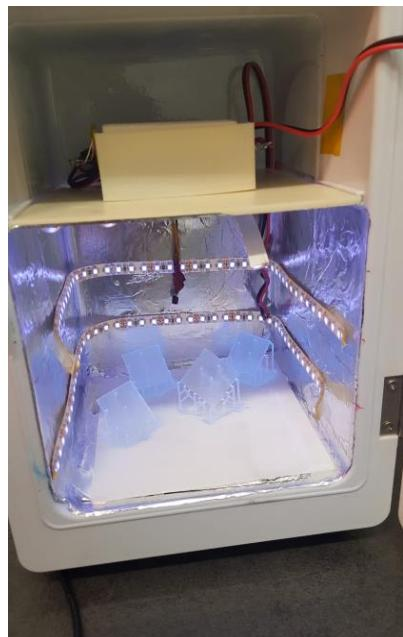
Slika 12. Naknadno očvršćivanje poliakrilatnih pločica
