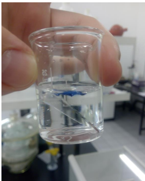
Slika 22. Odvajanje filma NB/PVC od staklene pločice tijekom kondicioniranja u puferskoj otopini
