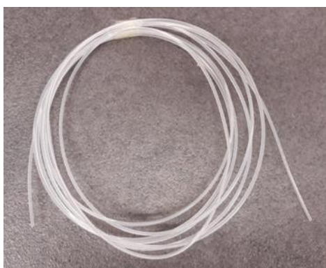
Slika 6. Komercijalni polimerni materijal (Z-ABS) u obliku filameta
