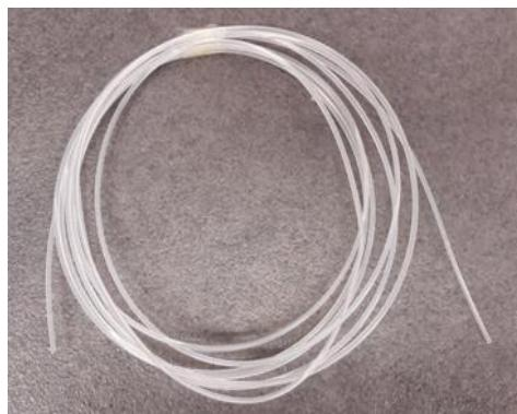
Slika 6. Komercijalni polimerni materijal (Z-ABS) u obliku filimenta
