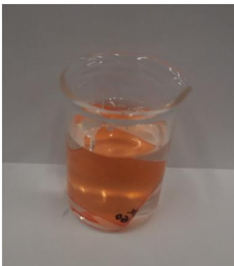
Slika 16. Kondicioniranje u puferskim otopinama
