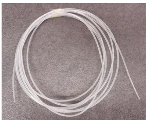
Slika 6. Komercijalni polimerni materijal (Z-ABS) u obliku filameta
