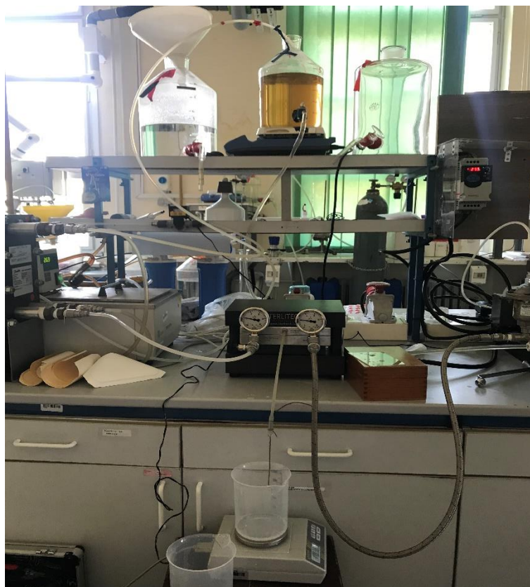
Slika 3.2. Laboratorijski membranski uređaj
