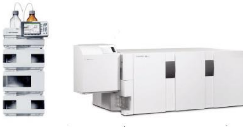
Slika 8. Agilent 1200 HPLC kromatograf vezan s trostrukim kvadrupolnim spektrometrom masa 6410
