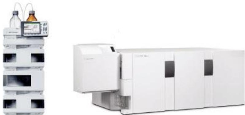
**Slika 8.** Agilent 1200 HPLC kromatograf vezan s trostrukim kvadrupolnim spektrometrom
