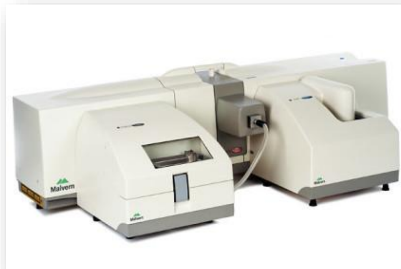
Slika 21. Uređaj za određivanje raspodjele veličina čestica Malvern
