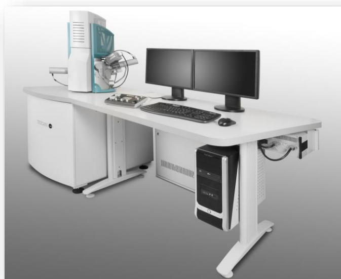
Slika 22. Uređaj za određivanje topografije površine suhих kristala Tescan Vega 3 SEM
