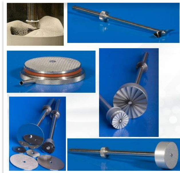
Slika 24. Dijelovi uređaja Freeman FT4
