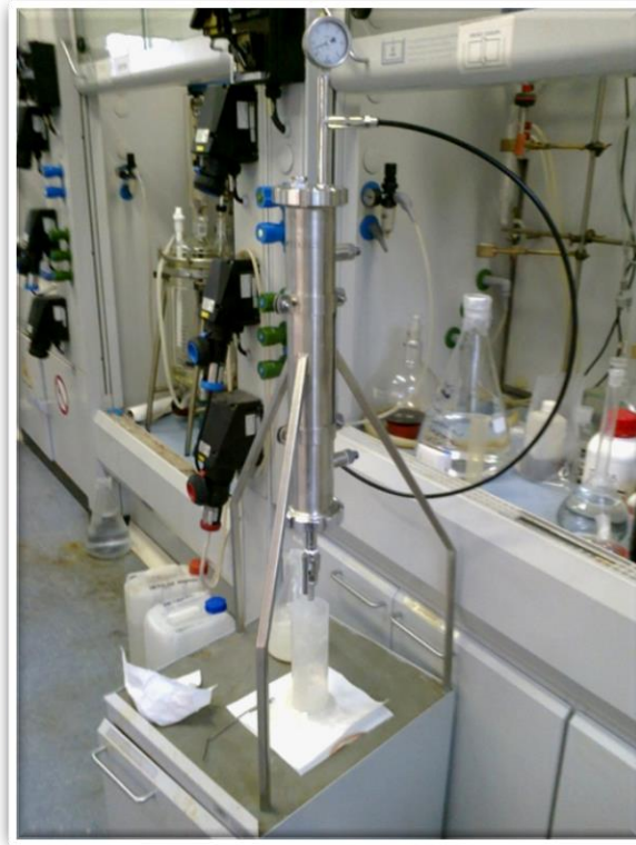
Slika 16. Tlačna filtracijska cijev za provedbu filtracije
