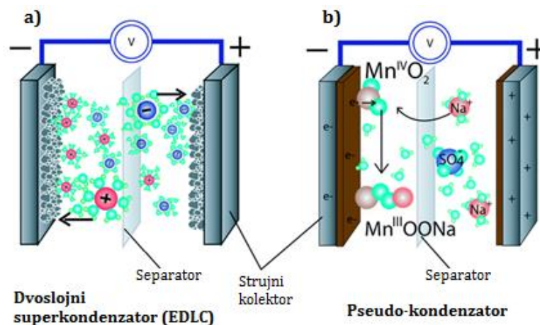
Slika 2.12 Princip rada a) dvoslojnog superkondenzatora (EDLC) i b) pseudokondenzatora.
