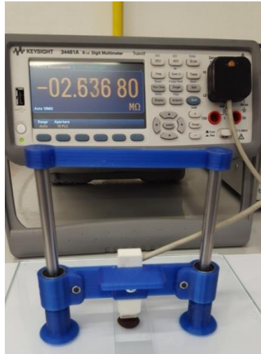
Slika 3.7 Uređaj i sonda za mjerenje električnog otpora.
