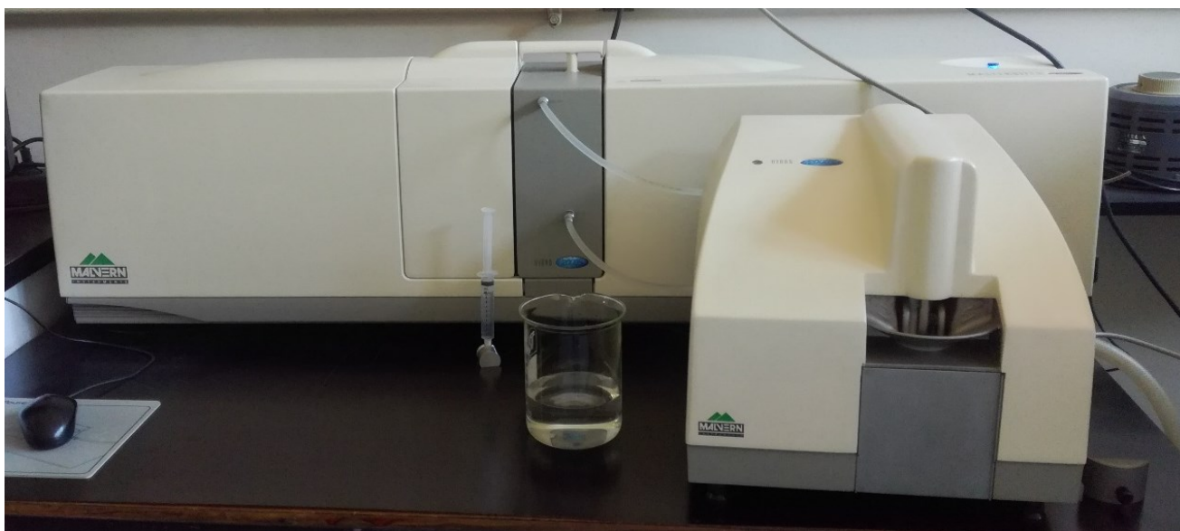
Slika 20. Malvern Mastersizer 2000 instrument za mjerenje veličine čestica.
