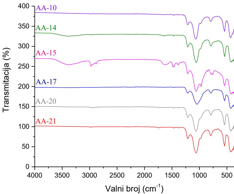
Slika 23. FTIR spektri uzorka zeolita sintetiziranih u prisutnosti algi prikazani kao ovisnost transmitacije o valnom broju.
