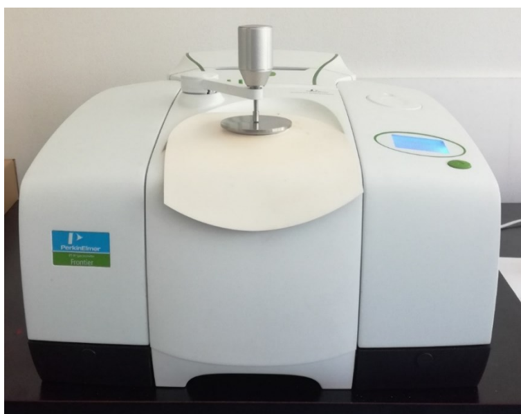
Slika 18. FTIR-ATR PerkinElmer instrument s dijamantnim kristalom.
