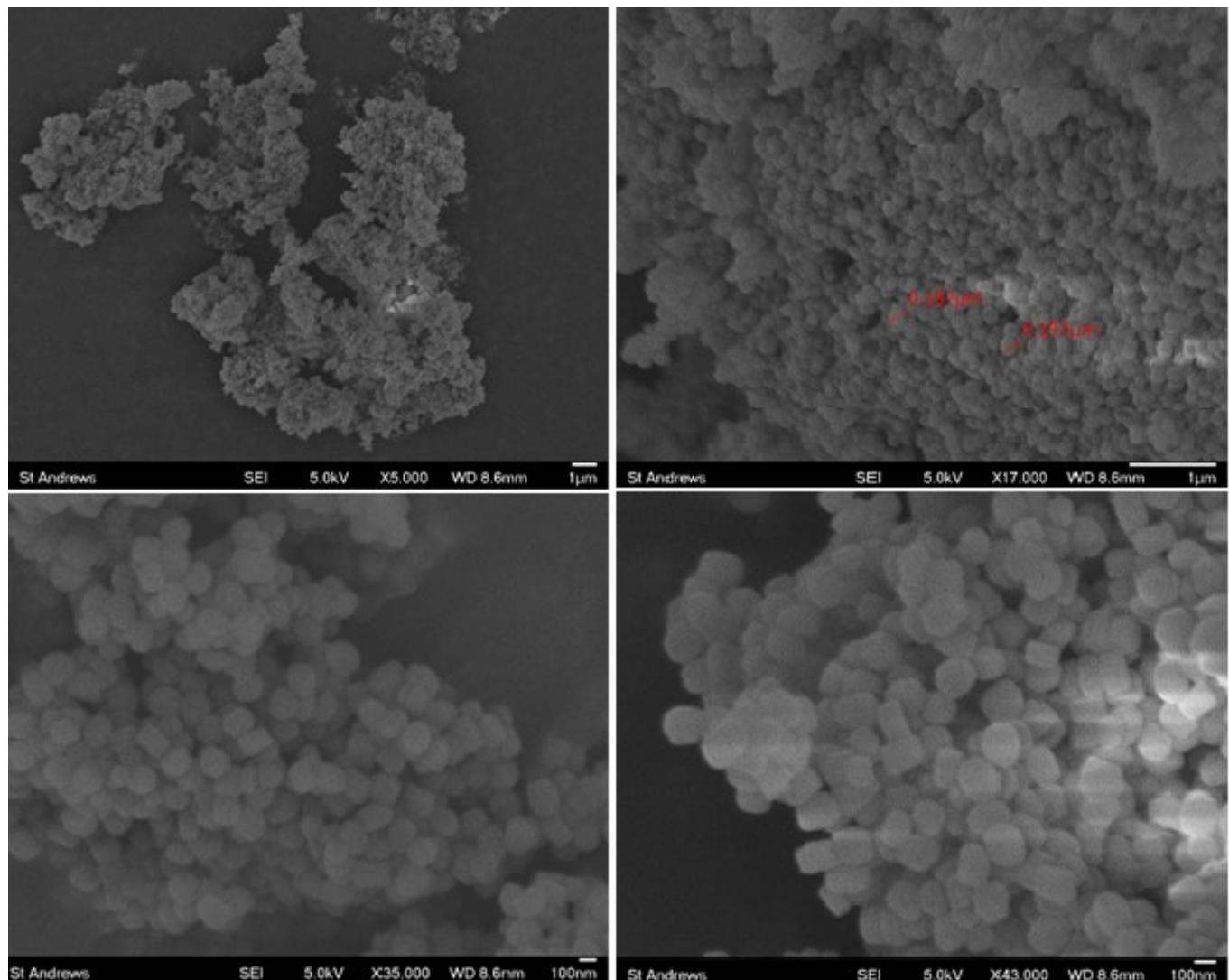
Slika 36. Mikrografije uzorka AA-14 snimljene na SEM-u uz povećanje slike 5.000x (gore lijevo), 17.000x (gore desno), 35.000x (dolje lijevo) i 43.000x (dolje desno).
