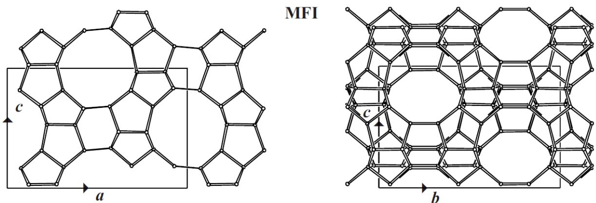
Slika 6. Ortoromska jedinična čelija MFI strukture [17].
