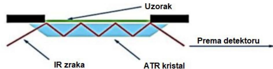
Slika 11. Princip rada ATR tehnike [53].
