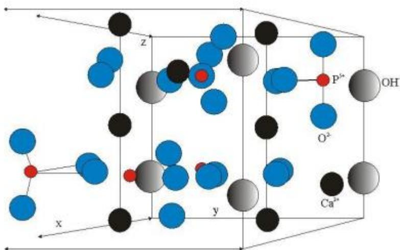
Slika 2. Shema kristalne strukture hidroksiapatita<sup>53</sup>
