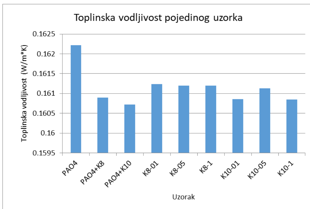
Slika 3.4.2. Promjena toplinske vodljivosti uzoraka u odnosu na PAO4 ulje
