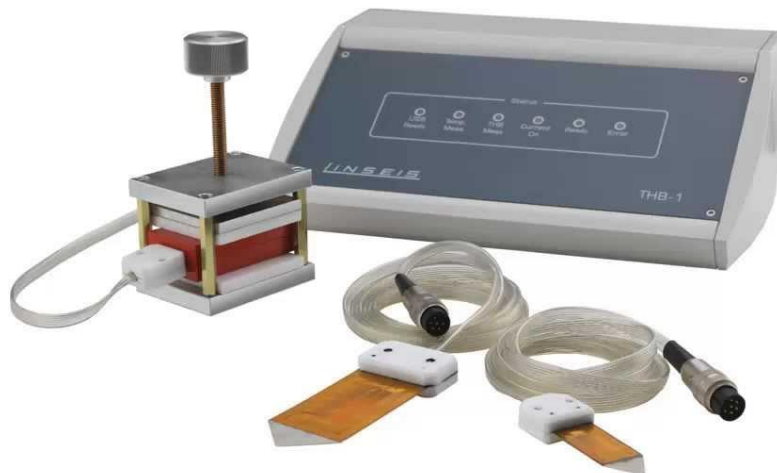
Slika 2.2.3. Uređaj za mjerenje toplinske vodljivosti Linseis THB
