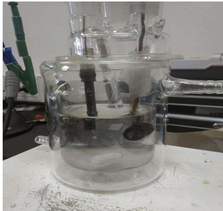
Slika 10. Troelektrodni sustav
