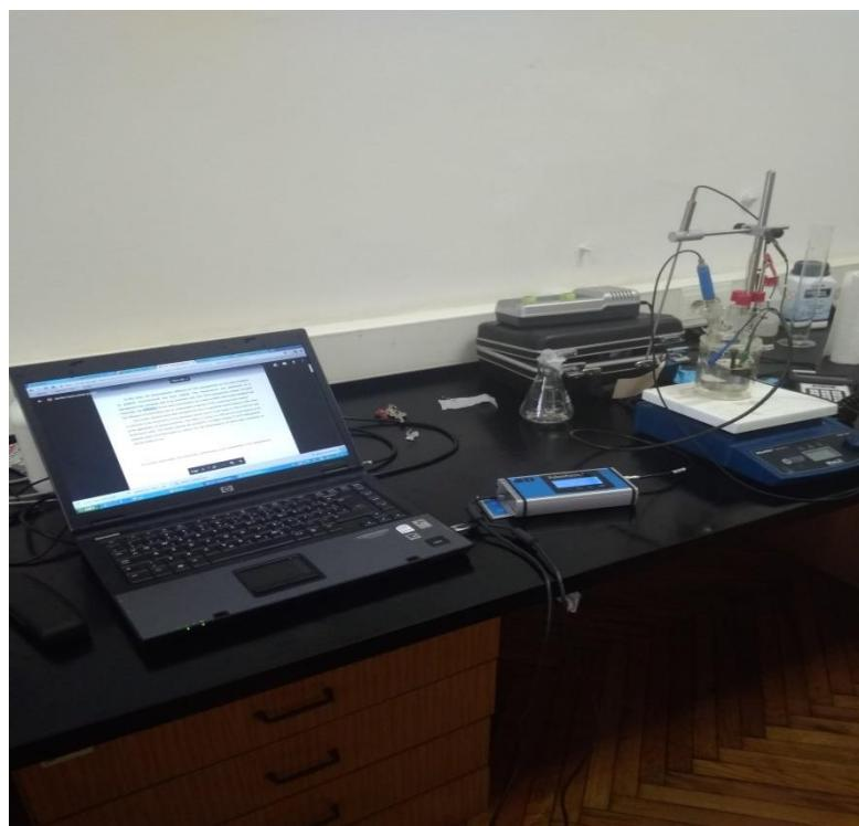
Slika 11. Aparatura za elektrokemijska ispitivanja.
