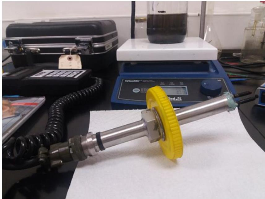
Slika 12. Formirani inhibitorski sloj PTB+PEG+ŠKROB na elektrodoma LPR probe
