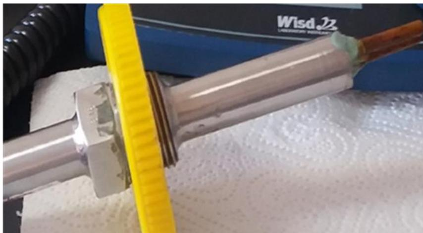
Slika 13. Formirani sloj hrđe na elektrodama LPR probe
