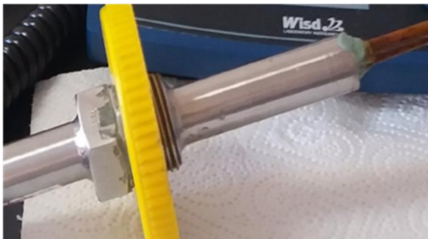
Slika 13. Formirani sloj hrđe na elektrodama LPR probe
