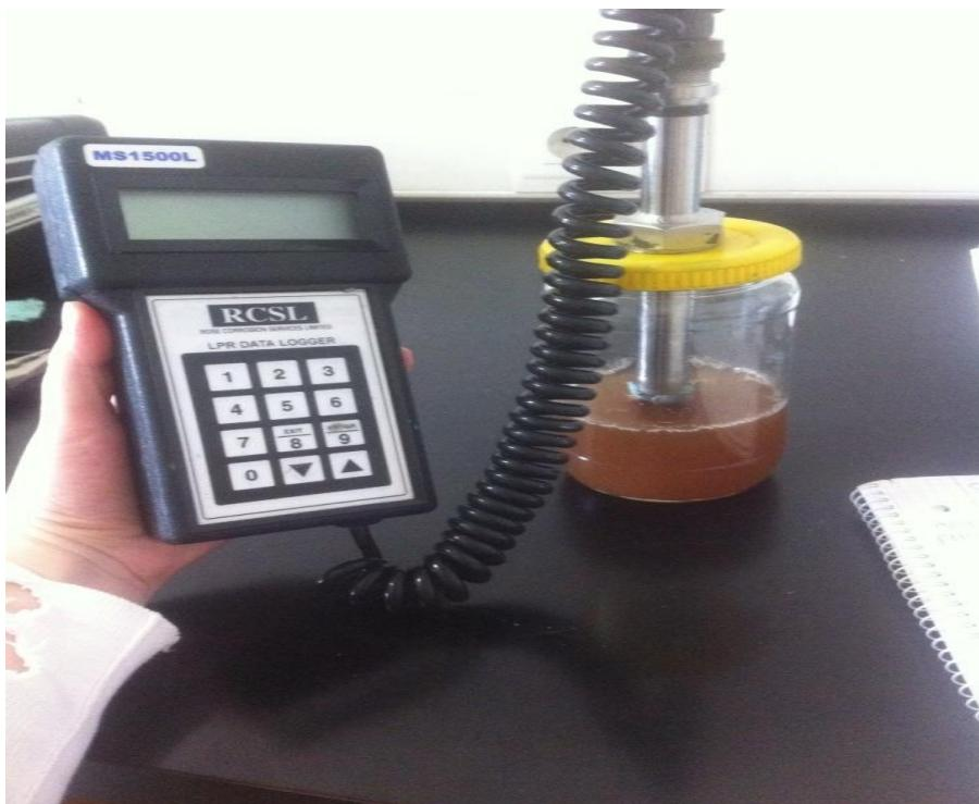
Slika 9. Izgled aparature za korozijski monitorng LPR probom
