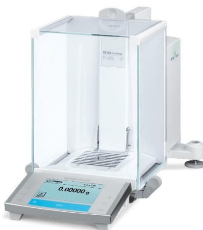
Slika 3.2 Analitička vaga XA105DU [22]
