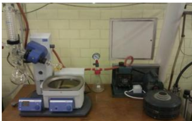
Slika 3.1. Rotacijski vakuum isparivač IKA RV 10, Basic
