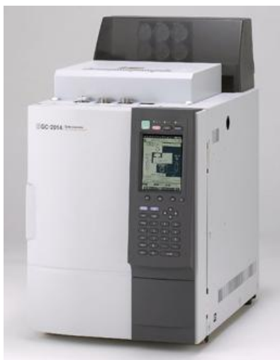
Slika 3.10. Plinski kromatograf Shimatzu GC 2014
