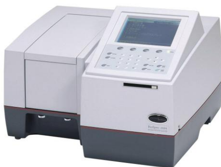
Slika 3.9. UV VIS spektrofotometar, Shimadzu UV-128 .
