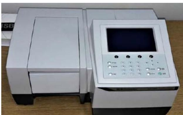
**Slika 21.** Fotografija spektrofotometra (UV-1280, Shimadzu, Kyoto, Japan).
