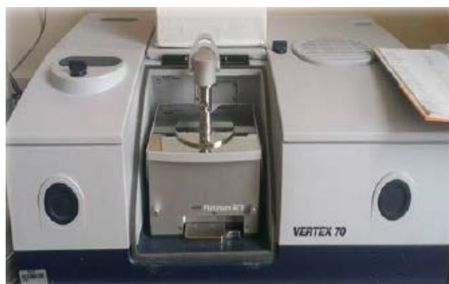
Slika 19. Fotografija FTIR spektrofotometra Vertex 70 s platinastim detektorom (Bruker, Billerica, SAD).
