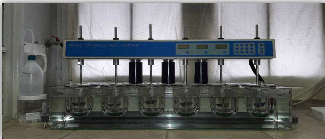
Slika 24. Fotografija uređaja za ispitivanje otpuštanja djelatne tvari RC-6D (Zhengzhou Nanbei Instrument, Henan, NR Kina).
