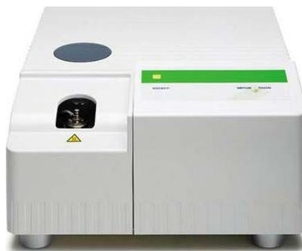
**Slika 18.** Fotografija diferencijalnog pretražnog kalorimetra Mettler Toledo 822<sup>e</sup> (Mettler Toledo GmbH, Greifensee, Švicarska).
