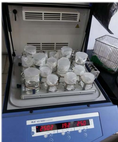
**Slika 20.** Fotografija laboratorijske tresilice IKA KS 3000 (IKA<sup>®</sup>-Werke GmbH & Co. KG, Staufen, SR Njemačka).
