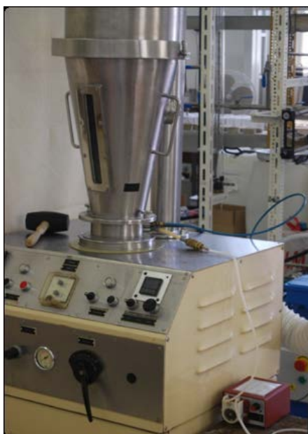
Slika 16. Fotografija granulatora s fluidiziranim slojem Uni-Glatt (Glatt GmbH, Binzen, SR Njemačka).
