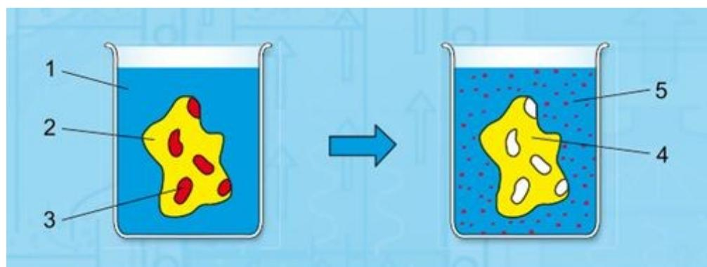
**Slika 10.** Shema procesa ekstrakcije kruto-kapljevito (1-otapalo, 2-materijal za ekstrakciju, 3-prijelazna komponenta, 4-osiromašeni materijal za ekstrakciju, 5-otapalo sa otopljenom prijelaznom komponentom) [21]
