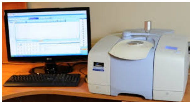
Slika 3.4.1. Perkin-Elmer Spectrum One FTIR spektrometar
