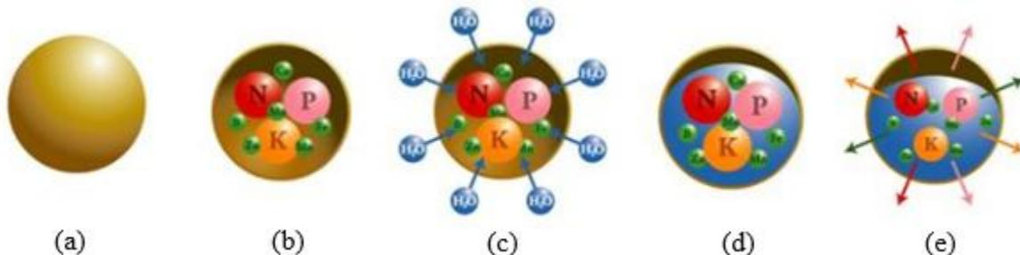
**Slika 2.** Difuzijski mehanizam otpuštanja aktivne tvari iz obložene granule gnojiva, (a) granula gnojiva s polimernim filmom, (b) hranjive (aktivne) tvari unutar granule, (c) prodiranje vode kroz polimerni film u unutrašnjost granule, (d) otapanje gnojiva i rast osmotskog tlaka, (e) kontrolirano oslobađanje hranjivih tvari kroz nabubrenu membransku ovojnicu/film [17].
