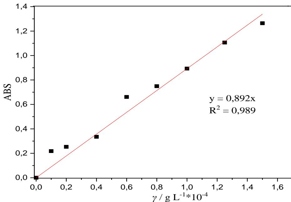
**Slika 6.** Baždarni pravac standardnih otopina  $\text{K}_2\text{HPO}_4$  snimljenih pri 880 nm
