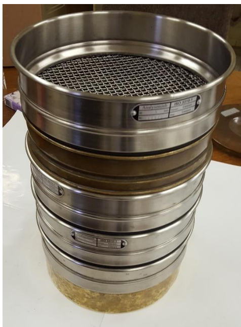
Slika 4. Sita različitih promjera otvor za razdvajanje granula gnojiva
