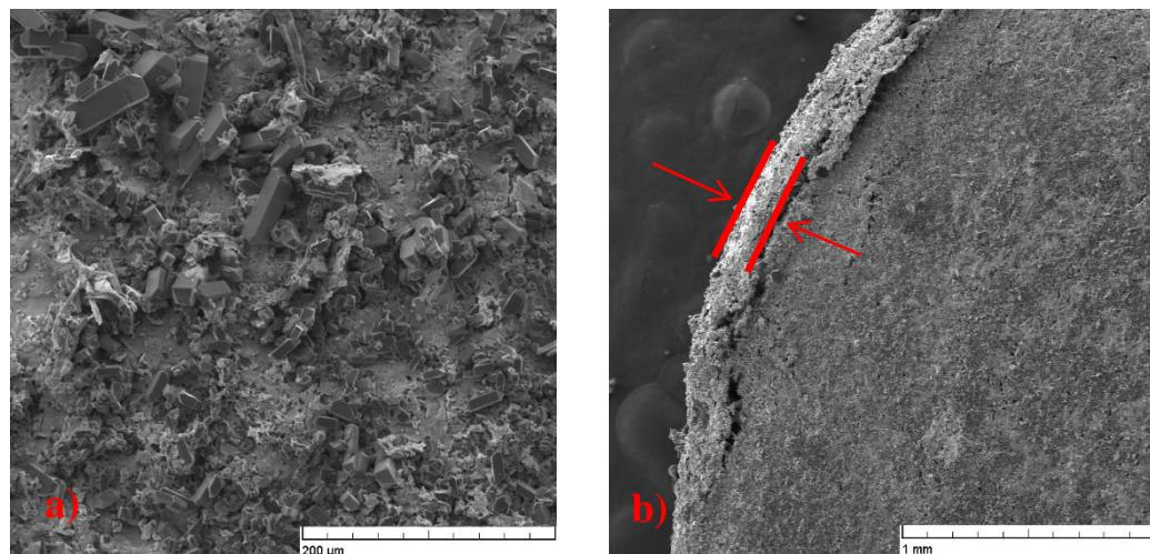
**Slika 20.** Prikaz a) površine i b) debljine polimernog filma granule gnojiva obloženom sustavom CA/PMMA 50/50 kroz 10 ciklusa oblaganja
