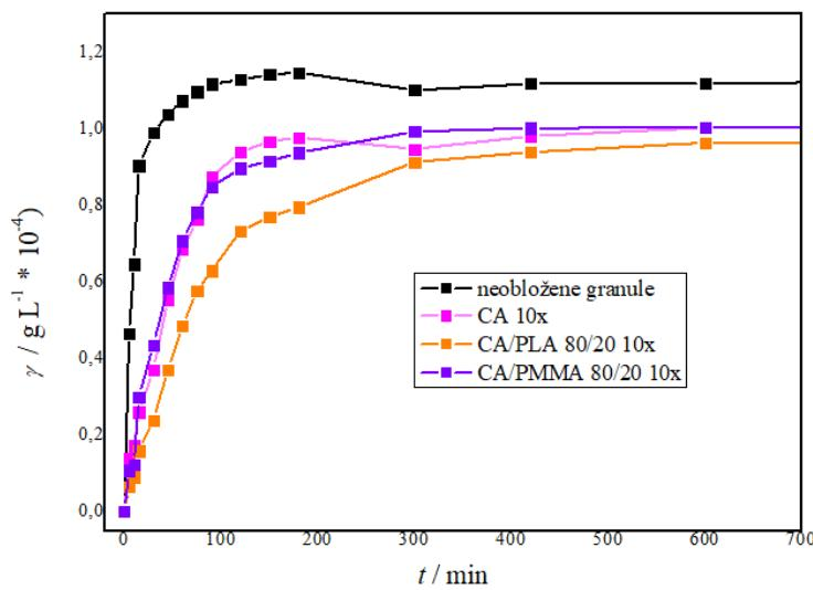
**Slika 28.** Usporedba profila otpuštanja fosfora za neobložene granule i granule obložene CA te mješavinama CA/PLA 80/20 i CA/PMMA 80/20 kroz 10 ciklusa oblaganja
