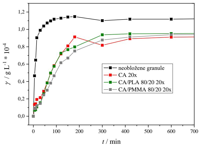
**Slika 29.** Usporedba profila otpuštanja fosfora za neobložene granule i granule obložene CA te mješavinama CA/PLA 80/20 i CA/PMMA 80/20 kroz 20 ciklusa oblaganja
