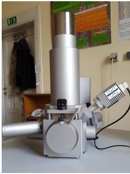
**Slika 7.** Pretražni elektronski mikroskop Tescan Vega III Easyprobe
