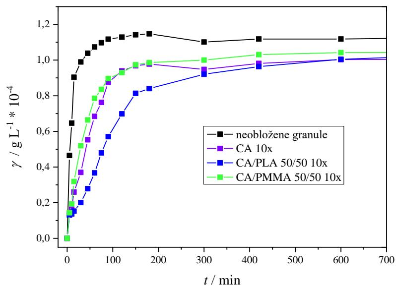
**Slika 30.** Usporedba profila otpuštanja fosfora za neobložene granule i granule obložene CA te mješavinama CA/PLA 50/50 i CA/PMMA 50/50 kroz 10 ciklusa oblaganja
