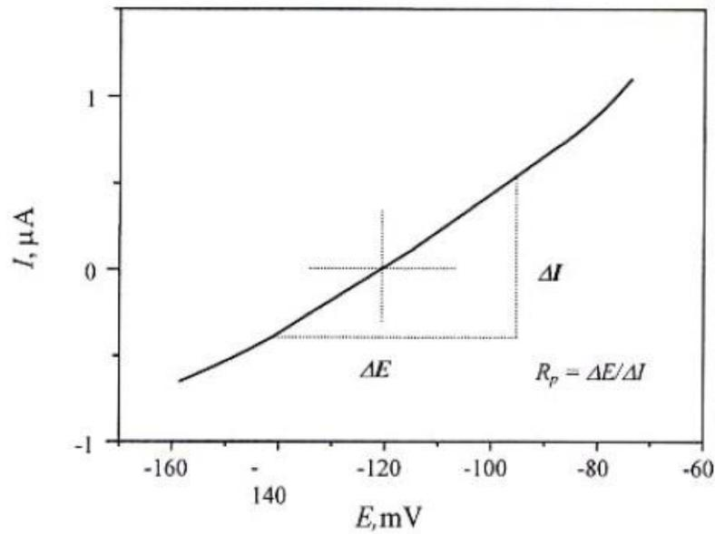
Slika 11. Određivanje polarizacijskog otpora<sup>2</sup>
