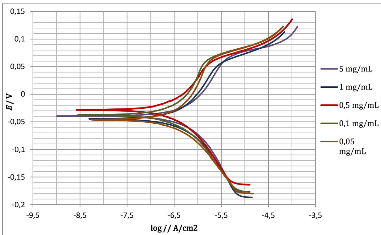
Slika 13. Grafička usporedba uzoraka tretiranih s 0,05 mg/mL, 0,1 mg/mL, 0,5 mg/mL, 1 mg/mL i 5 mg/mL etanolskom otopinom masne kiseline
