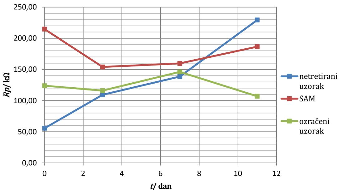
Slika 20. Promjena polarizacijskog otpora u vremenu za netertirani uzorak, uzorak sa SAM-om i ozračeni uzorak
