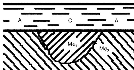
Slika 1. Prikaz anodnih i katodnih mjesta tijekom korozije <sup>3</sup>
