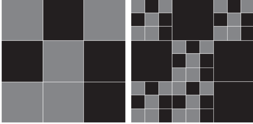
Slika 23. Shematska ilustracija fraktalnog modela čvrstih masa. Siva boja označava ponavljajuću fazu a crna označava fazu pora 23
