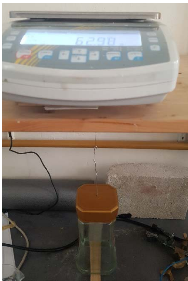
Slika 41. Uzorak PC uronjen u etil alkohol
