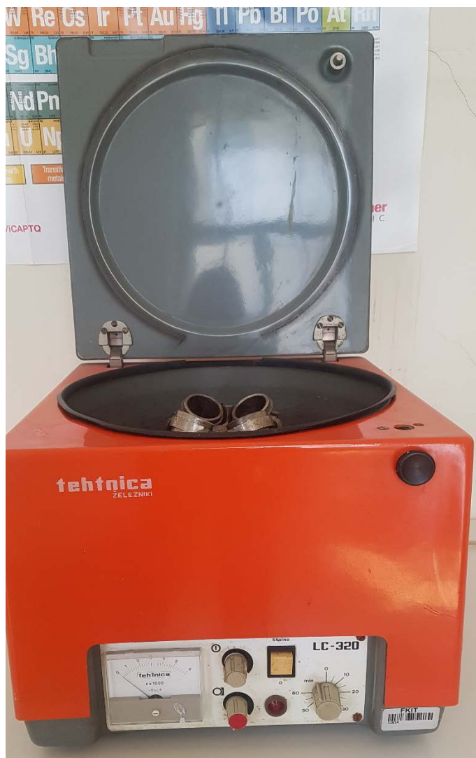
Slika 32. Centrifuga (Tehnica železniki LC-320)
