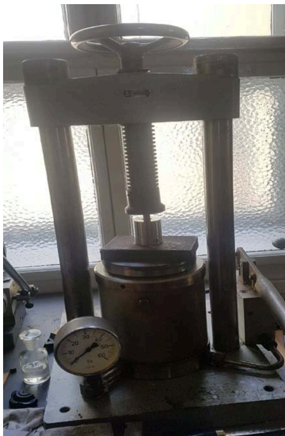
Slika 44. Ručna hidraulična preša s kalupom za pripravu tableta promjera 13 mm
