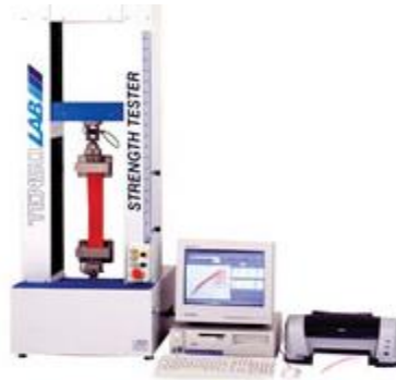
Slika 15. Mehanička kidalica MesdanLab Strength Tester
