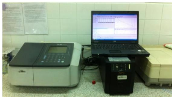
**Slika 3.2.** Dvozračni spektrofotometar
