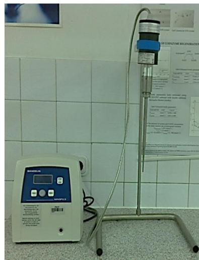
**Slika 3.3.** Ultrazvučni homogenizator
