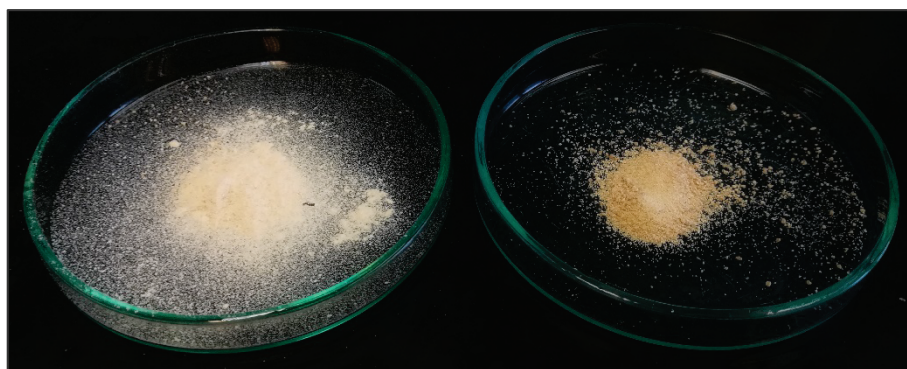
Slika 33. Nanočestice nakon (lijevo) i prije (desno) usitnjavanja i prosijavanja
