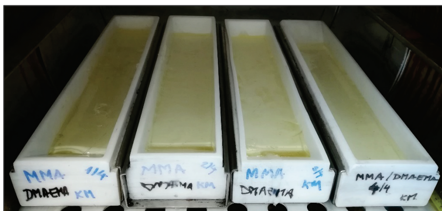
Slika 39. Sušenje M90D10 kopolimera u kalupima
