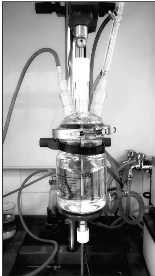
Slika 37. Laboratorijski reaktor za polimerizaciju (500 mL)
