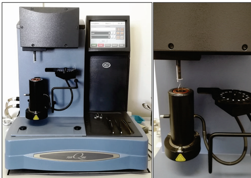
Slika 53. Laboratorijski TGA (lijevo) s približnom peći, kukicom za vagu i postoljem za uzorkovanje (desno)
