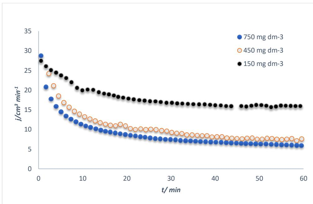
Slika 16. Graf pada protoka kao funkcija vremena za otopinu koja se sastoji od  $1 \text{ mM NaHCO}_3$ ,  $9 \text{ mM NaCl}$  i  $1 \text{ mM CaCl}_2$  pri  $\text{pH} = 6$  a.)  $750 \text{ mg dm}^{-3}$  alginata,
