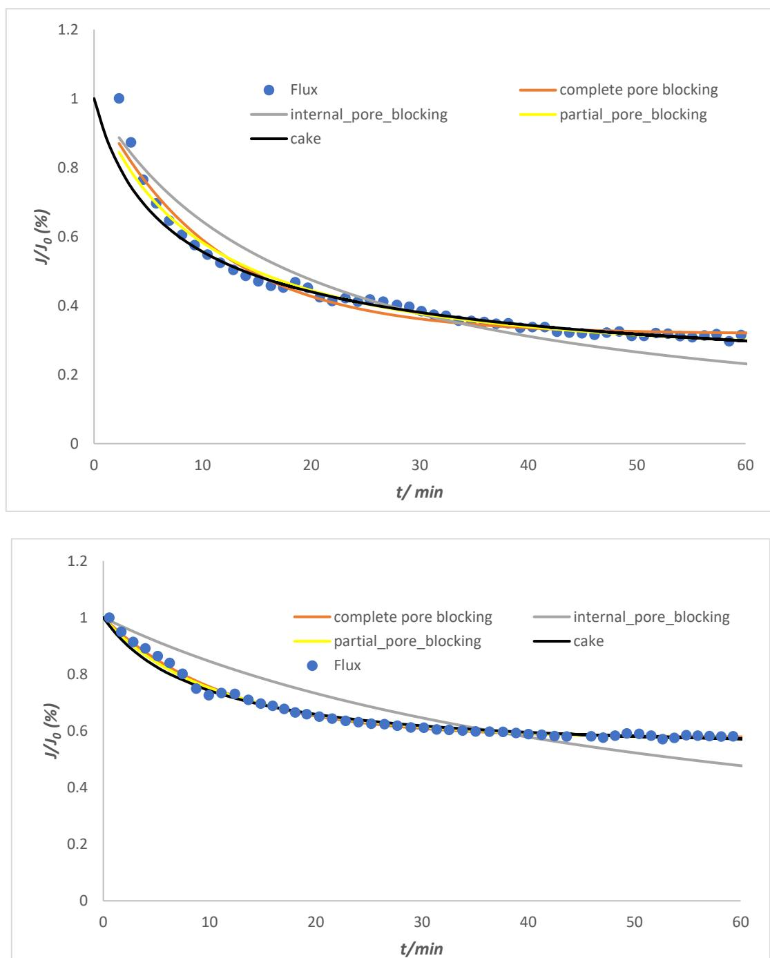
Slika 23. Gore- grafički prikaz modeliranja blokiranjem UF membrane za **450 mg dm<sup>-3</sup>** alginatne kiseline 1 mM NaHCO<sub>3</sub>, 9 mM NaCl i 1 mM CaCl<sub>2</sub> pri pH = 6, dolje - grafički prikaz modeliranja blokiranjem UF membrane za **150 mg dm<sup>-3</sup>** alginatne kiseline 1 mM NaHCO<sub>3</sub>, 9 mM NaCl i 1mM CaCl<sub>2</sub> pri pH = 6
