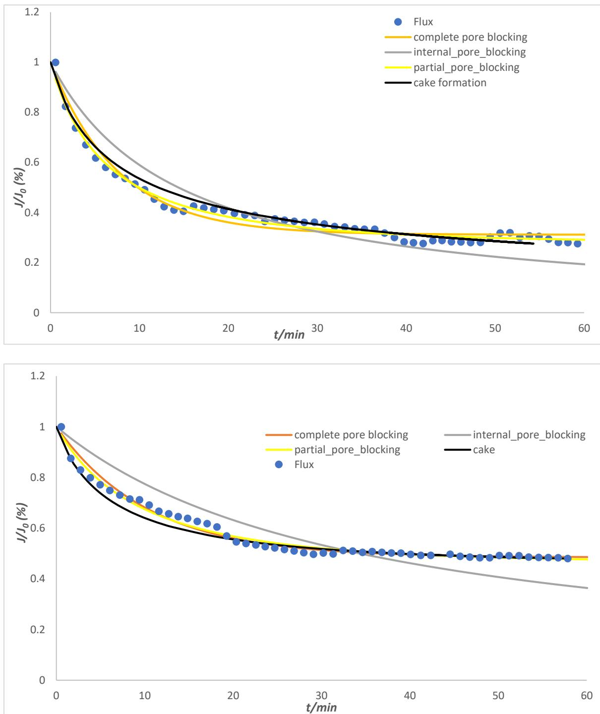
Slika 21. Gore- modeliranje blokiranjem membrane sa kalcijevim kloridom koncentracije 0.5 mM, dolje- modeliranje blokiranjem membrane sa kalcijevim kloridom koncentracije 4 mM
