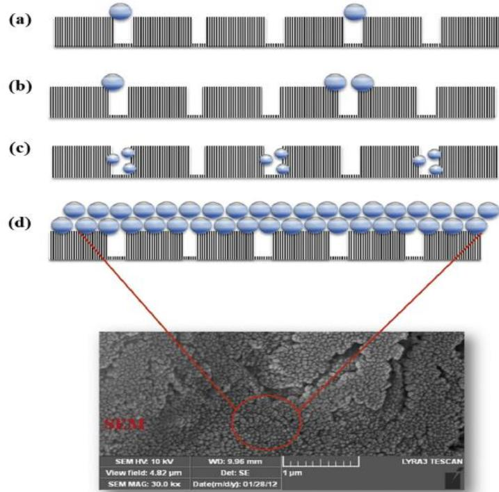
Slika 11. Shematski prikaz klasifikacije blokiranja porozne membrane. a) kompletno blokiranje pora ( $n = 2$ ), b) djelomično blokiranje pora ( $n = 1$ ), c) blokiranje unutarnjih pora ( $n = 1,5$ ), d) stvaranje kolača ( $n = 0$ ) s SEM slikom blokirane površine membrane
