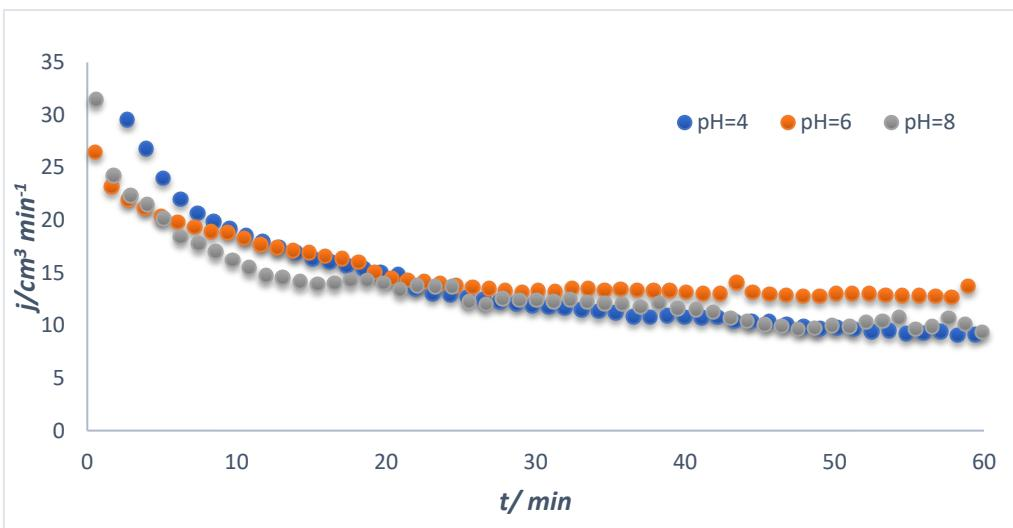
Slika 14. Graf pada protoka kao funkcija vremena za otopinu koja se sastoji od  $750 \text{ mg dm}^{-3}$  alginata,  $1 \text{ mM NaHCO}_3$ ,  $9 \text{ mM NaCl}$  i **4 mM CaCl}\_2** pri a) pH = 4, b) pH = 6, c) pH = 8
