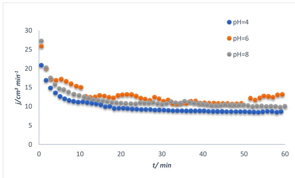
Slika 17. Graf pada protoka kao funkcija vremena za otopinu koja se sastoji od  $750 \text{ mg dm}^{-3}$  alginata,  $1 \text{ mM NaHCO}_3$ ,  $9 \text{ mM NaCl}$  pri a)  $\text{pH} = 4$ , b)  $\text{pH} = 6$ , c)  $\text{pH} = 8$
