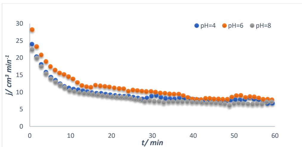
Slika 15. Graf pada protoka kao funkcija vremena za otopinu koja se sastoji od  $750 \text{ mg dm}^{-3}$  alginata,  $1 \text{ mM NaHCO}_3$ ,  $9 \text{ mM NaCl}$  i **0,5 mM CaCl}\_2** pri a) pH = 4, b) pH = 6, c) pH = 8
