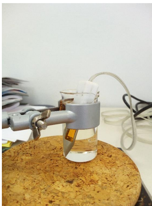
Slika 3.2.5.2. Čaša s uzorkom u koju je uronjen senzor THB6K99 i koji je spojen na Linseis – THB
