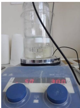
Slika 23. Homogenizacija otopina na magnetskoj miješalici
