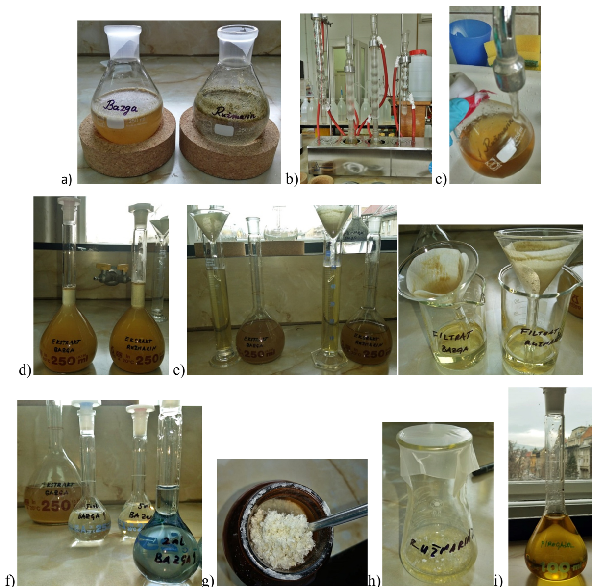
Slika 14. Određivanje ukupnih polifenola i trjeslovina; a) priprema vodenog ekstrakta u tikvici; b) ekstrahiranje zagrijavanjem na vodenoj kupelji 30 minuta; c) hlađenje ekstrakta pod tekućom vodom; d) razrjeđivanje ekstrakta vodom do oznake; e) filtriranje i bacanje prvih 50 mL filtrata; f) priprema otopina za određivanje ukupnih polifenola g) kožni prašak; h) kožni prašak pomiješan sa 10 mL filtrata; i) otopina pirogalola
