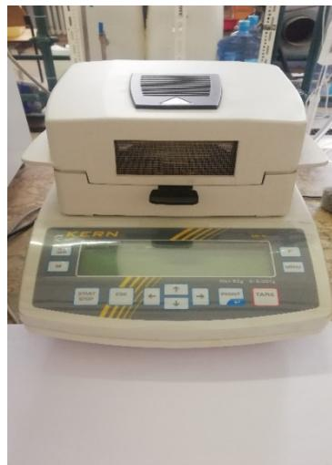
Slika 12. Uređaj za mjerjenje sadržaja vlage *Kern MLS 50-3C*
