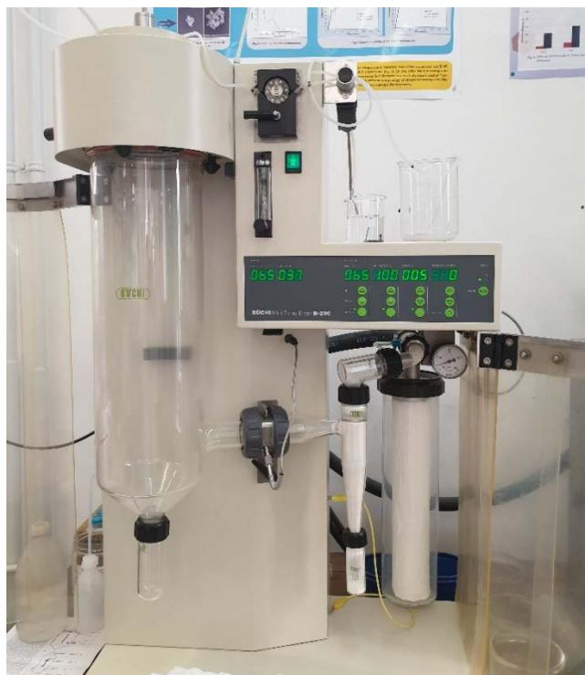
Slika 9. Sušionik s raspršivanjem *Mini Spray Dryer B-290*
