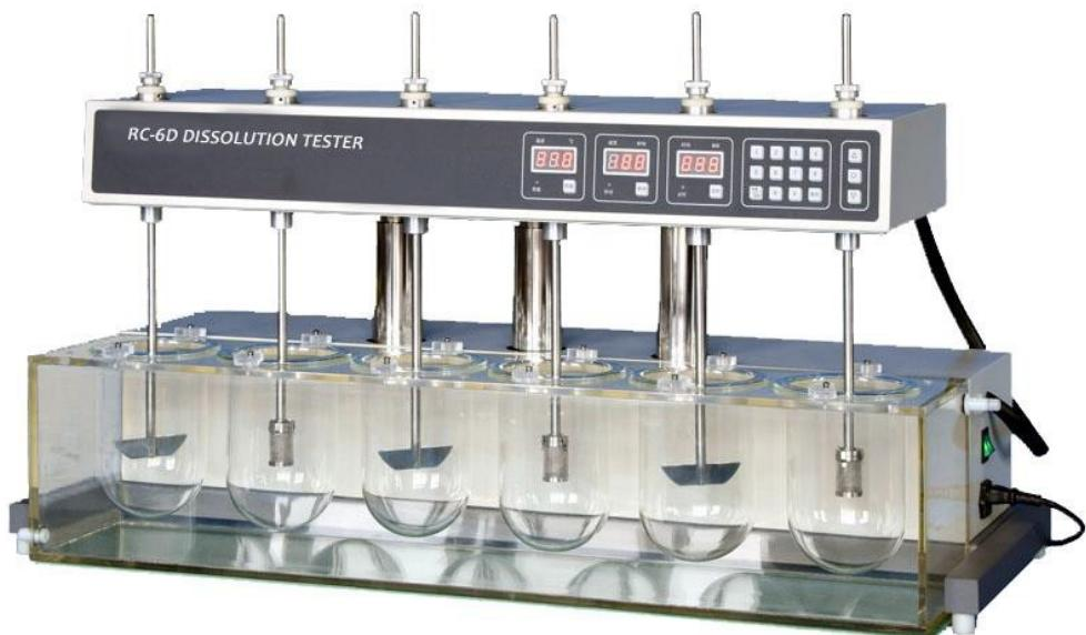
Slika 13. Uređaj za ispitivanje oslobođanja djelatnih tvari (RC-6D, *Zhengzhou Nanbei Instrument*)
