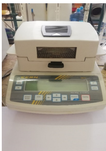
Slika 12. Uređaj za mjerenje sadržaja vlage Kern MLS 50-3C
