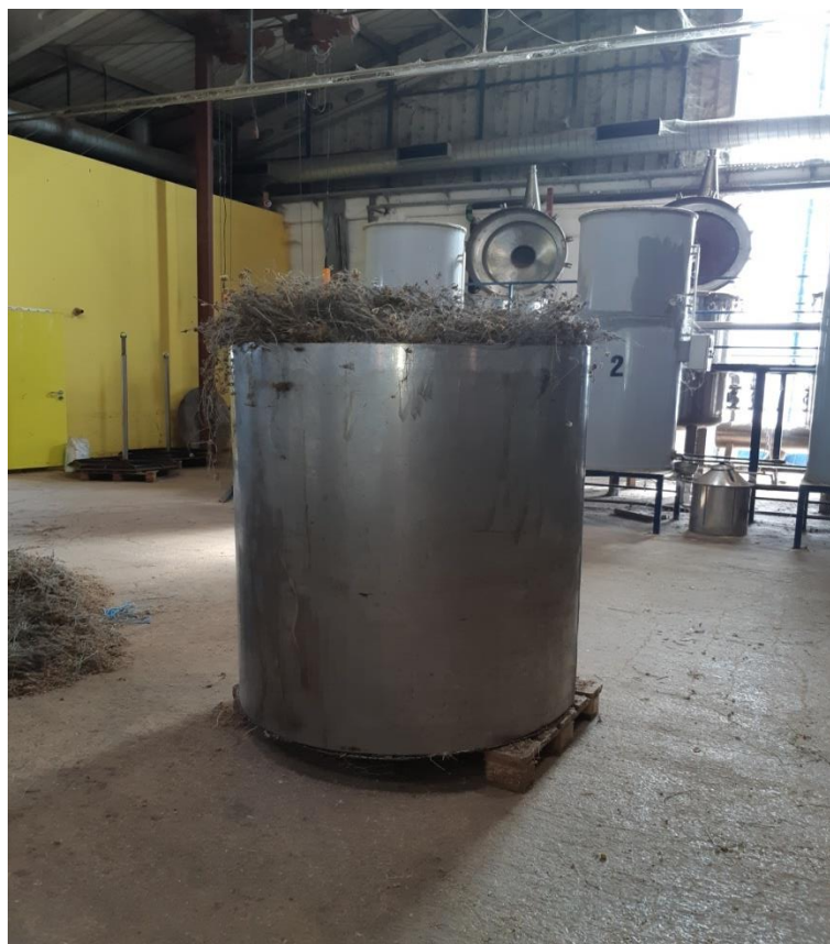
Slika 12. Smilje pripremljeno za punjenje u kotao za destilaciju
