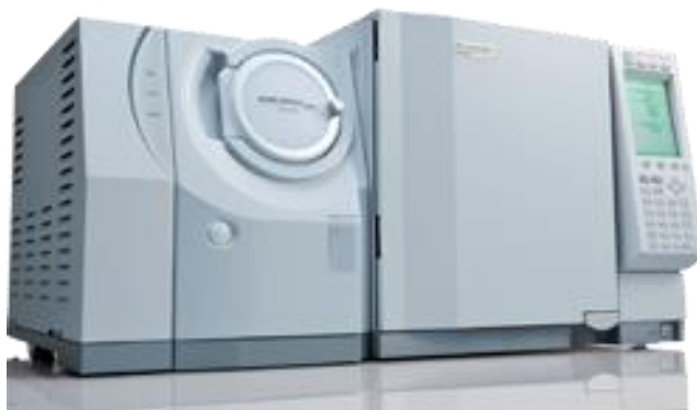
Slika 14. Plinski kromatograf QP 2010 plus sa spektrometrom masa
