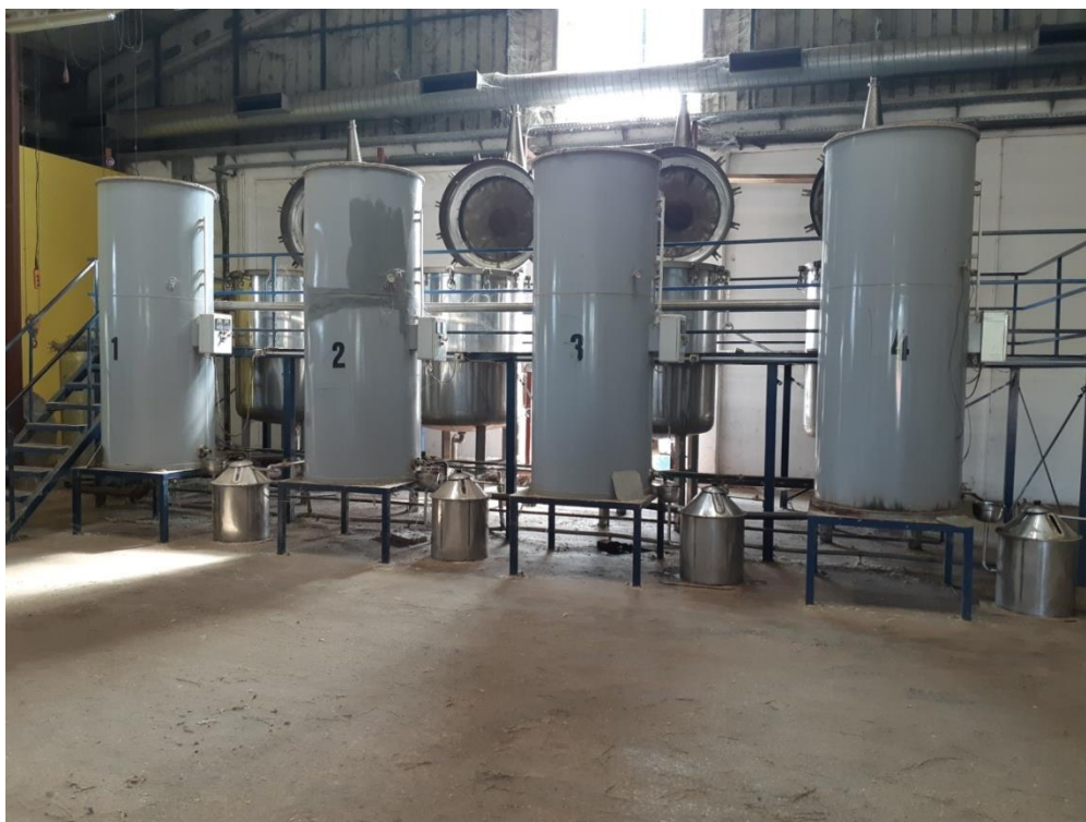
Slika 13. Postrojenje za destilaciju vodenom parom
