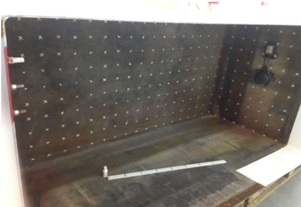
Slika 3-4. Označavanje ispitnih točaka u bazenu
