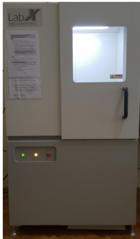
Slika 7. XRD 6000 (uređaj na kojem je odrađena rendgenska difrakcijska analiza)
