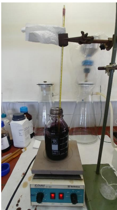
Slika 12 Pročišćavanje pirolitičkog ulja adsorpcijom
