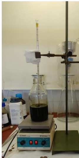
Slika 11 Sušenje pirolitičkog ulja
