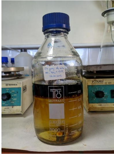
Slika 16 Ispiranje ulja destiliranom vodom
