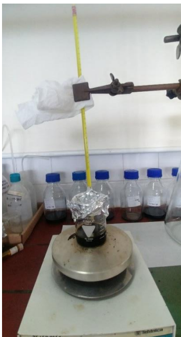
Slika 20 Ekstrakcijska desulfurizacija uz DES 2
