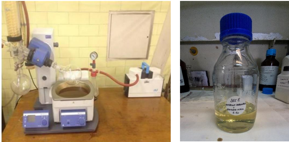
Slika 10 Vakuum isparivač (lijevo) pripremljeno otapalo (desno)
