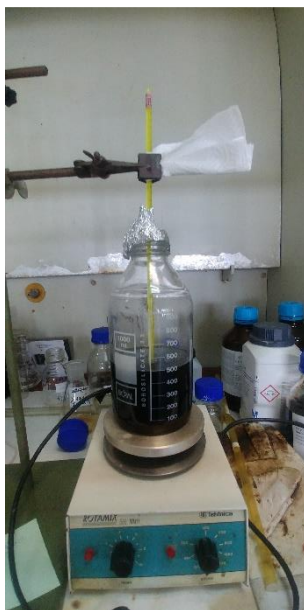
Slika 14 Ekstrakcija srednje frakcije ulja pomoću DES8
