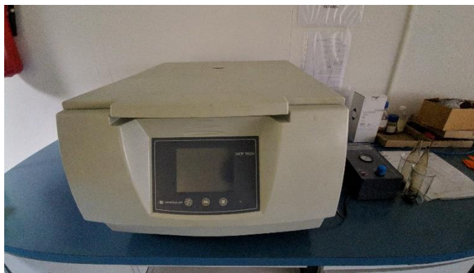
Slika 13 Centrifuga za naftu i mineralna ulja Normalab
