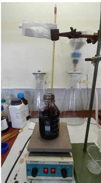
Slika 12 Pročišćavanje pirolitičkog ulja adsorpcijom
