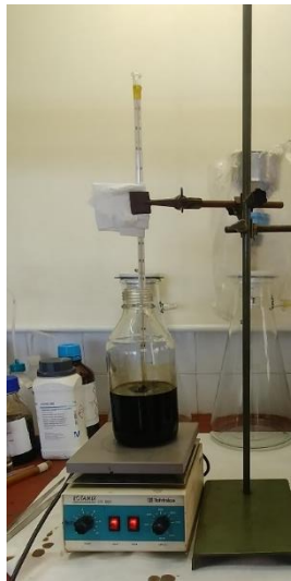
Slika 11 Sušenje pirolitičkog ulja
