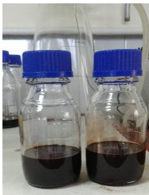
Slika 18 Gornji slojevi nakon desulfurizacije uz H_2SO_4
