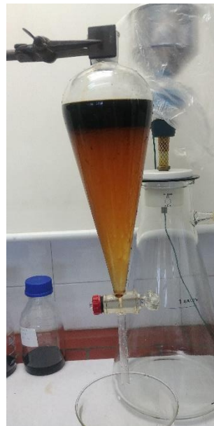
Slika 17 Odijeljivanje slojeva u lijevku za odijeljivanje
