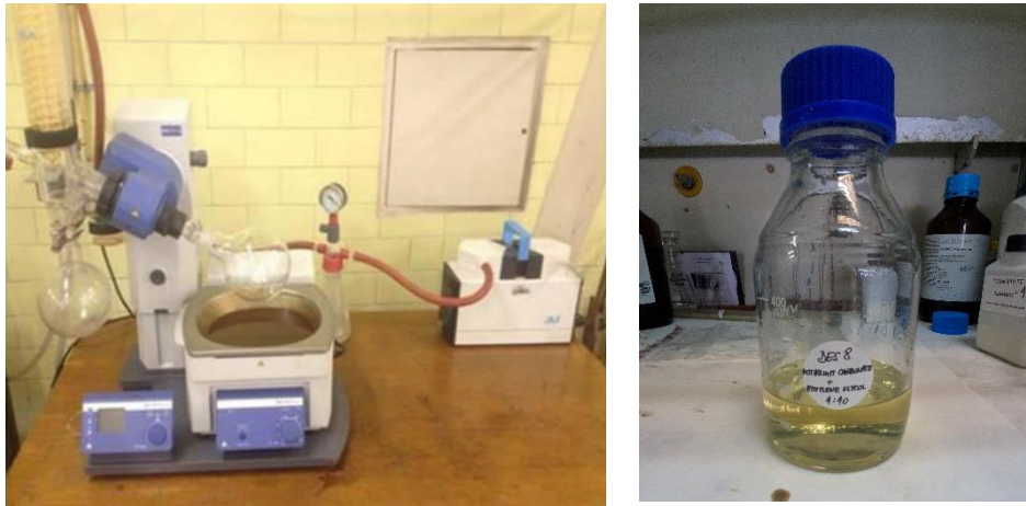
Slika 10 Vakuum isparivač (lijevo) pripremljeno otapalo (desno)
