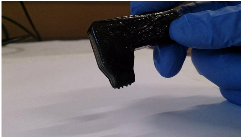
Slika 3.10. Sonda s četiri vrha za mjerenje električne provodnosti.
