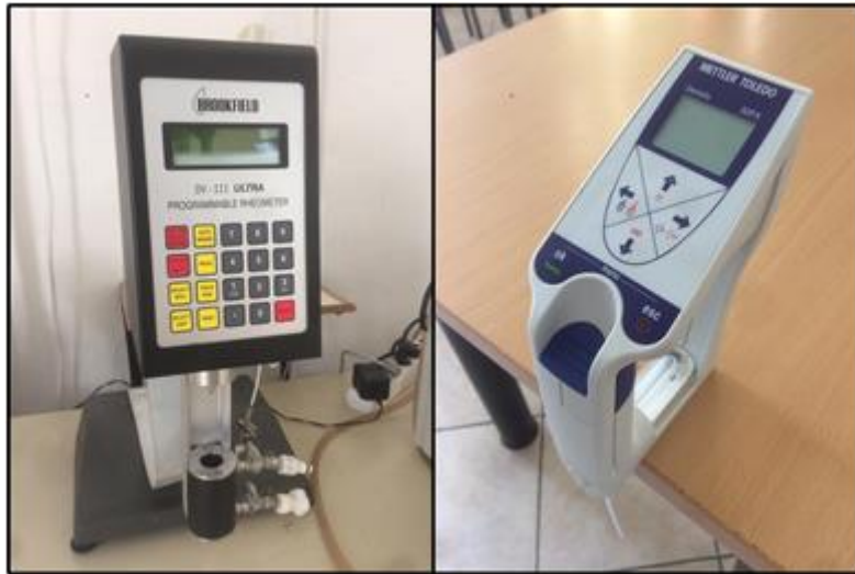
Slika 19. DV-III Ultra reometar lijevo, Densito 30PX densitometar desno.
