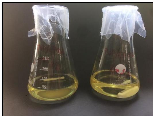
Slika 25. Pripremljeni gelovi PVP/EtOH.
