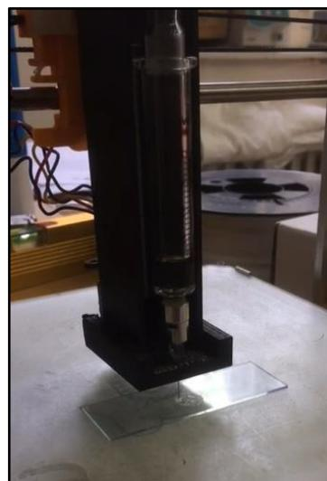
Slika 14. Inicijalni testovi tiskanja jednostavnih oblika gelovima.
