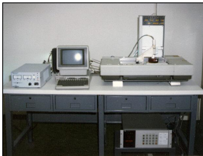
Slika 1. SLA-1, prvi uređaj za 3D-tisak za komercijalne usluge Chucka Hulla.[8]
