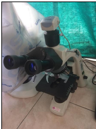
Slika 18. Mikroskop s kamerom BA200 proizvođača Motic.
